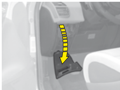
Acceso a la segunda caja de fusibles baja la plancha de a bordo
