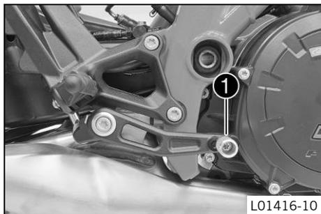
El pedal del freno ❶ se encuentra delante del reposapiés derecho. El pedal del freno permite accionar el freno trasero.
