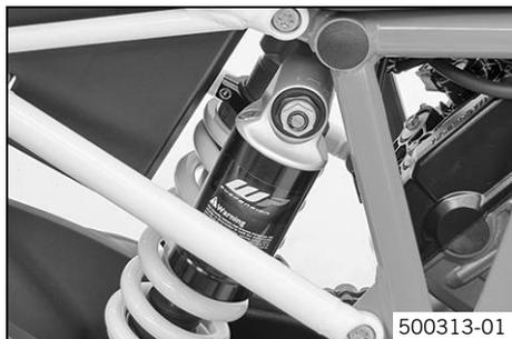
La amortiguación de la compresión del amortiguador está dividida en dos gamas, High Speed y Low Speed.
