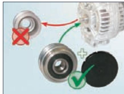
Fig. 2: Substituição da roda livre do alternador.
