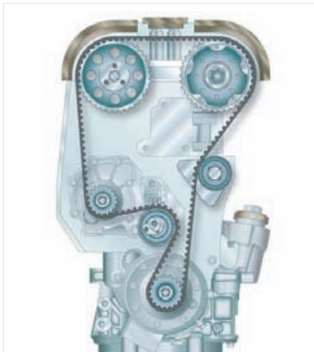
A chamada transmissão auxiliar é utilizada para accionar os grupos auxiliares, como por exemplo o alternador, a bomba do líquido de arrefecimento, a bomba da direcção assistida ou o compressor do ar condicionado. Esta função costumava ser desempenhada pela correia trapezoidal estriada, que transmitia o binário da cambota ao alternador e à bomba do líquido de arrefecimento, com perdas de binário causadas por patinagem.
