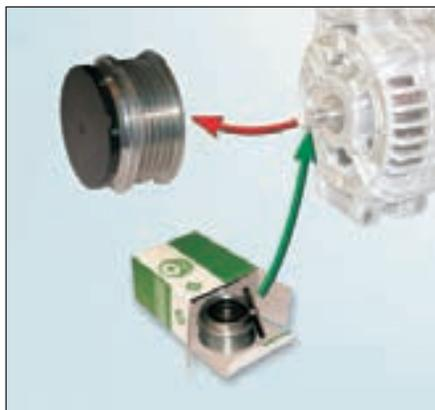
Fig. 1: *Recomendação: Substituição da polia livre do alternador*
