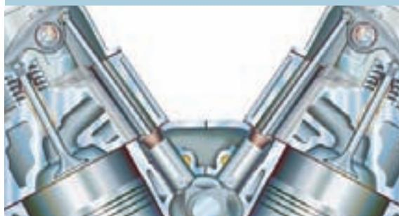
As árvores de cames de montagem inferior são instaladas por debaixo da linha divisória da culatra e do corpo do cilindro. O accionamento das válvulas de um motor com estas características também é designado por accionamento de válvulas à cabeça ou na culatra (OHV).
