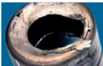
Desgaste adesivo-abrasivo até atingir o colapso total. No entanto, é necessário efectuar uma comprovação intensiva da posição da árvore de cames.
