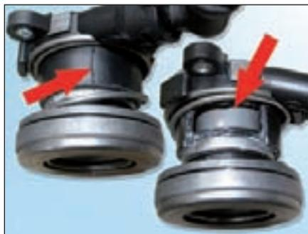
Fig. 5: Rolamento hidráulico danificado por uma instalação incorrecta
