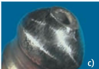
O forte desgaste abrasivo na cabeça de esfera atinge um nível crítico. O desgaste provocou uma mudança da forma geométrica da cabeça de esfera.
