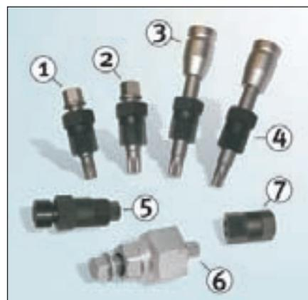
Fig. 5: Ferramentas especiais necessárias para a montagem e desmontagem das diferentes polias do alternador
