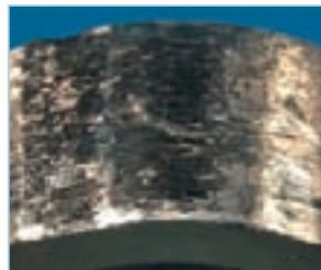
Desgaste significativo no diâmetro exterior da árvore de cames, com uma geometria claramente modificada da árvore de cames.
