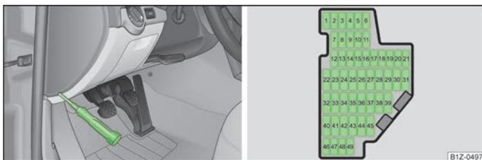
Fig. 158 Tapa de la caja de fusibles en el tablero de instrumentos/Representación esquemática de la caja de fusibles
