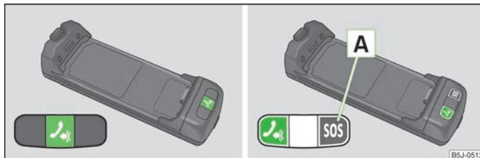
Fig. 107 Imagen esquemática: Adaptador monotecla/adaptador bitecla
