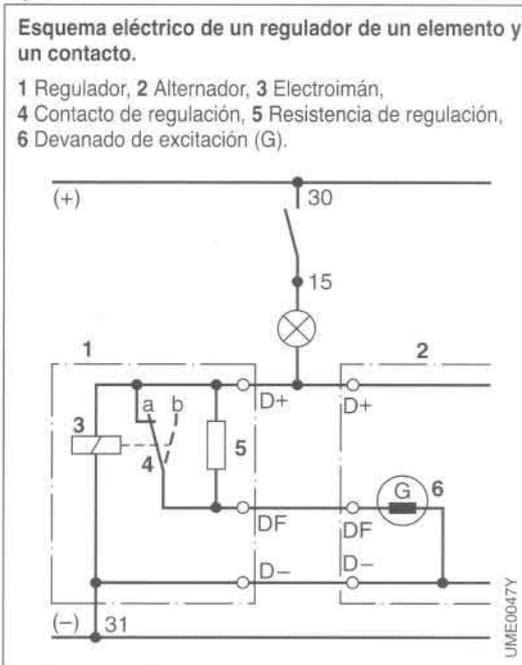
En el regulador de un elemento y un contacto, los contactos abren y cierran como sigue (fig. 1): Sobre el inducido del regulador actúa por una parte la fuerza magnética y por otra la fuerza elástica de un muelle de ajuste y suspensión.
