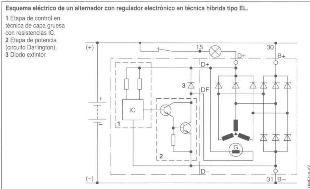
saturación de la capacidad del alternador). La conexión L está prevista para activaciones de relés de hasta 0,5 A como máximo. La potencia de pérdida de la lámpara de control del alternador en el cuadro de instrumentos es, con frecuencia, demasiado alta y perturbadora, pero puede reducirse p. ej. mediante transición a una indicación LED. Los reguladores de tensión multifuncionales permiten activar indistintamente bombillas o diodos LED como elementos indicadores.
