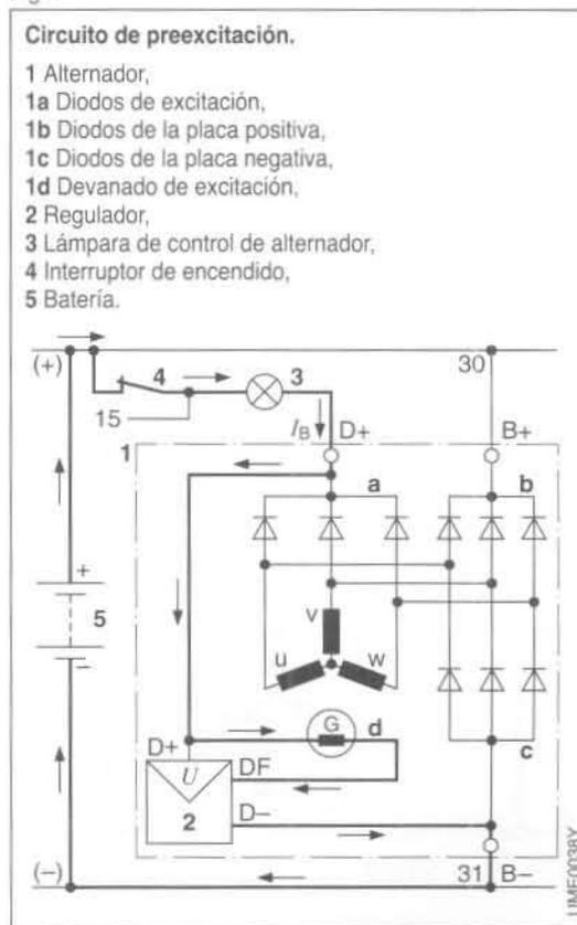
Esta tensión no es suficiente para provocar una autoexcitación destinada a la creación del campo magnético.
