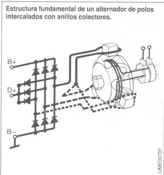
modernos motores de vehículos con régimen de ralentí reducido. La velocidad de giro máxima aumentada del alternador (20.000 min<sup>-1</sup> durante breve tiempo) permite una mayor desmultiplicación, por lo que estos alternadores pueden entregar hasta un 25 % más de potencia con una misma velocidad de giro del motor que, p. ej., los alternadores en versión monobloc.
