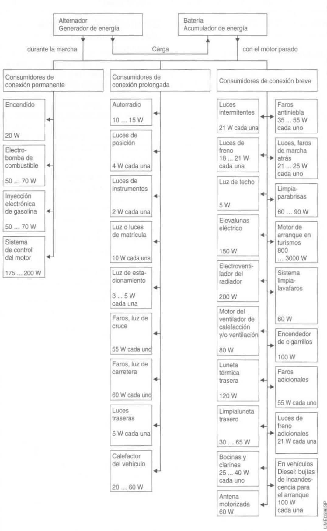
(acondicionador de aire en verano, calefacción del asiento en invierno). La frecuencia de conexión del ventilador eléctrico del radiador depende de la temperatura y de las condiciones de marcha.
