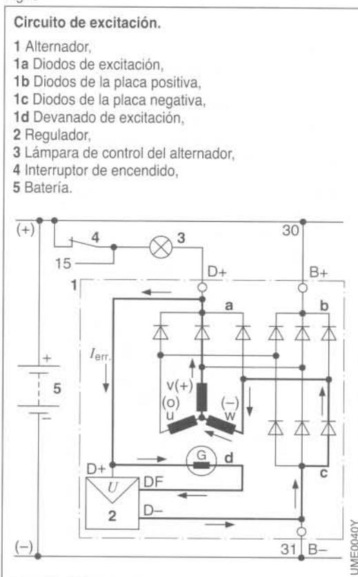
potencia, para ser transmitida después a la batería y a los consumidores. La corriente del alternador  $I_G$  pasa desde los tres devanados, a través de los diodos de potencia, a la batería y a los consumidores del sistema eléctrico del vehículo.
