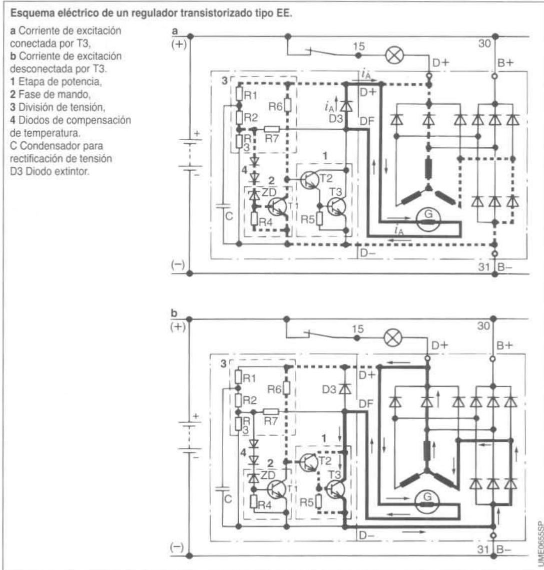
Debido a la conexión Darlington en la etapa final de potencia (dos transistores), la caída de tensión en la dirección de flujo es de 1,5 V aproximadamente.
