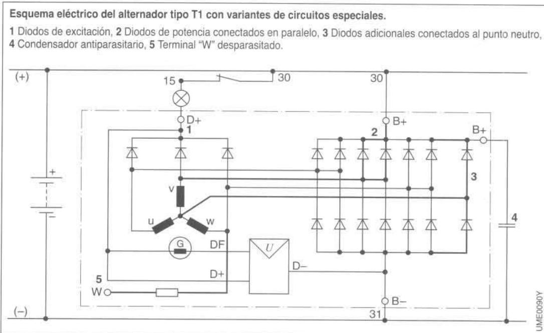
(fig. 2). Normalmente, la energía que contiene se perdería como potencia disipada, pero mediante otros dos diodos, conectados como diodo positivo y negativo al punto neutro (fig. 1), esta corriente puede rectificarse. Esto conduce, a partir de una velocidad de rotación del alternador de aproximadamente  $3.000 \text{ min}^{-1}$ , a un aumento de potencia que alcanza como máximo un 10 %. Estos diodos adicionales aumentan la ondulación de la tensión del alternador.
