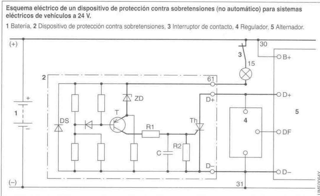
cortocircuito, es decir, al quitar el contacto o en caso de parada del motor o del alternador. Si se invierten los terminales D+ y D- al montar el aparato, éste no ofrece protección contra sobretensiones.
