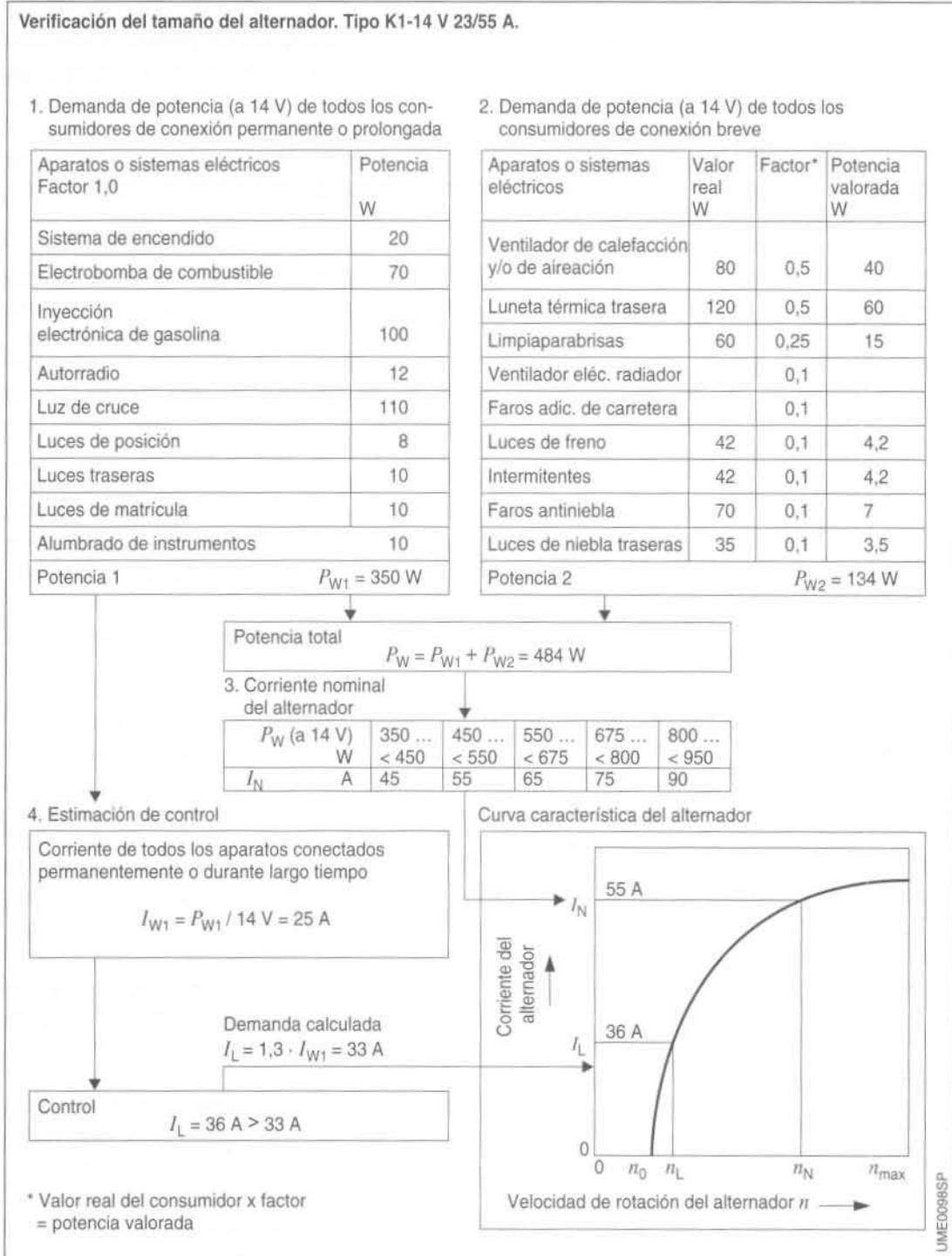
2. Calculando la demanda de potencia de todos los consumidores de conexión breve, a 14 V.
