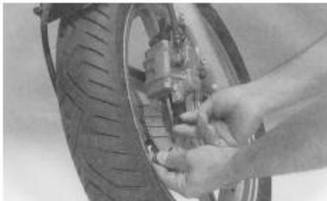
Extraer el eje y recuperar las dos pastillas por la parte inferior de la pinza.
