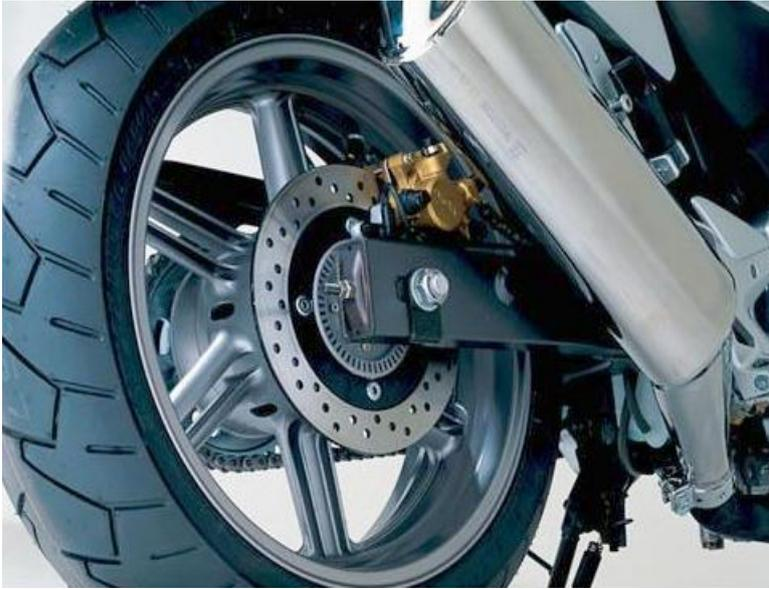
Actuar sobre las tuercas de los tensores de ambos brazos del basculante apretando o aflojando, según sea necesario tensar o destensar la cadena, actuar poco a poco sin forzar los tornillos a fin de no doblar la corona. Si apretamos con fuerza el tornillo del tensor incluso después de haber notado resistencia, la cadena quedará tan tensa que incluso puede alabear la
