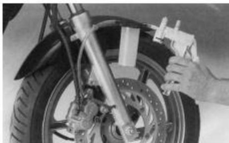
Actuar sobre la maneta de freno y mientras mantenemos la presión, desenroscar ligeramente el tornillo de purga (llave de 8 mm.). No cerrar el sangrador hasta que la maneta del freno esté a media carrera. No llevar jamás el mecanismo del freno hasta el tope a riesgo de dañar el pistón.
