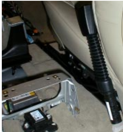
Fig. 106: Los tensores de cinturón para conductor y acompañante en el X5 son piezas de nuevo desarrollo. Su funcionamiento y técnica son conocidos (como p.ej. E46/E39).
