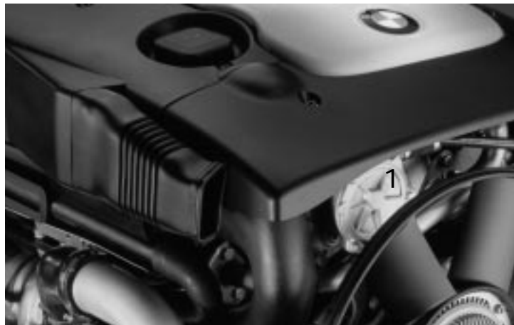
Fig. 61: M57 Bomba de depresión (1)
