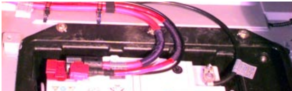
Fig. 107: La batería del X5 con SBK (borne de batería de seguridad) se encuentra en la cubeta multifuncional debajo de la rueda de repuesto y de la unidad EHC.
