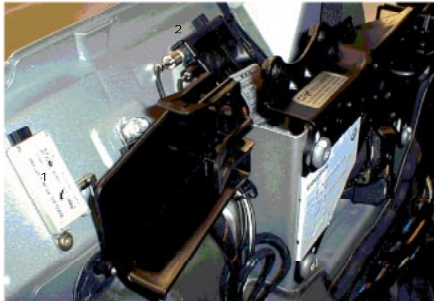
Fig. 137: 1. Amplificador de antena de TV 1 y 2. Antena diversity
