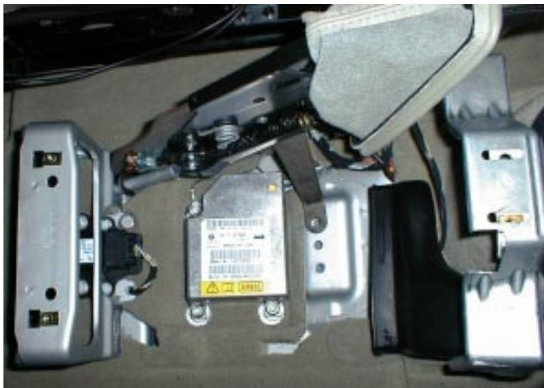
Fig. 105: La unidad de mando MRS III está atornillada a la plataforma del chasis debajo de la consola central posterior (debajo del soplador del acondicionador de aire para el fondo, si está montado).
