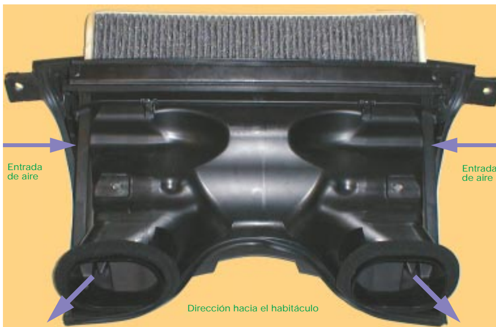
Fig. 111: El conducto del microfiltro en el X5 está atornillado con al salpicadero
