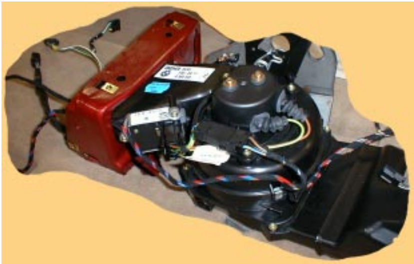
Fig. 125: X5 Ventilador de calefacción y aire acondicionado en la zona trasera, en estado montado (consola central, desmontada)
