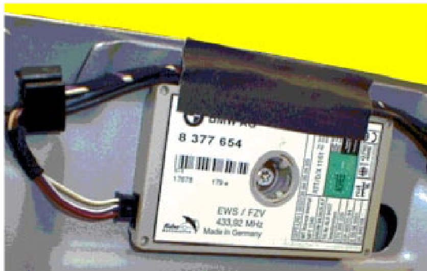
Fig. 138: Receptor FBZV. La antena está dispuesta debajo del spoiler del techo
