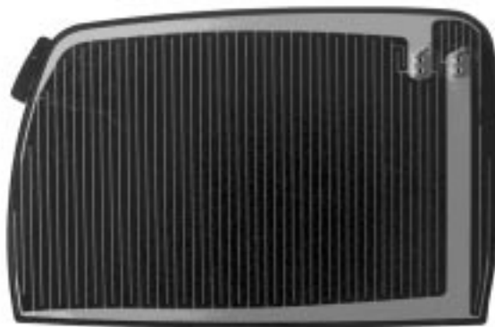
Fig. 89: Parte posterior del espejo con placa calefactora y conexión del X5
