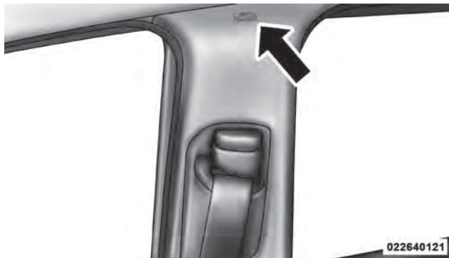
Ubicación de las cortinas inflables complementarias de las bolsas de aire laterales (SABIC)
