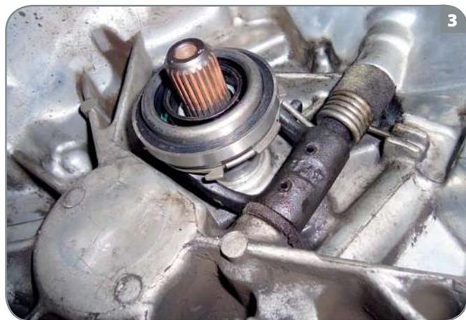
3. Posteriormente inicia el montaje del seguro del collarín (Figura 4). Coloca el seguro en una de las "anclas".
