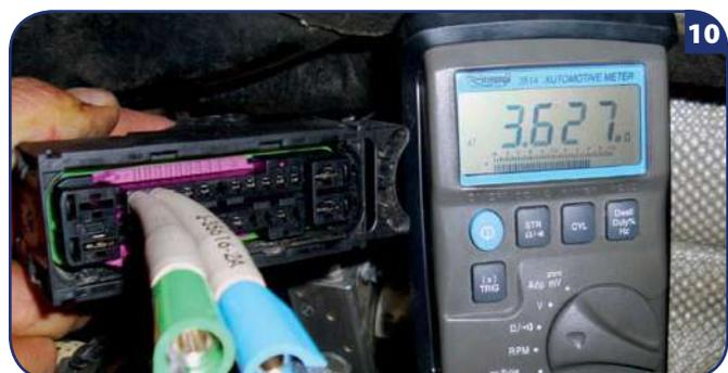
**NOTA:** Este tipo de sensores tienen polaridad, si realizas las pruebas de forma incorrecta, no obtendrás ningún valor.
