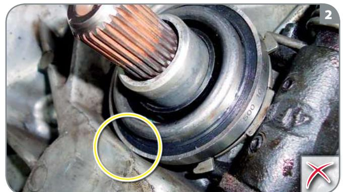
2. Coloca el collarín en el candeler y acciona con la mano la horquilla para facilitar la instalación del seguro (Fig. 3).
