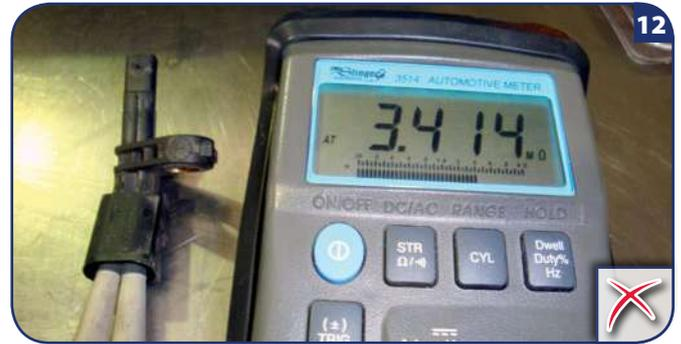
**NOTA:** Este tipo de sensores tienen polaridad, si realizas las pruebas de forma incorrecta, no obtendrás ningún valor.
