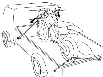
Para fijar la CRF, ate la rueda delantera a la parte frontal de la plataforma de carga del camión o riel del remolque.
