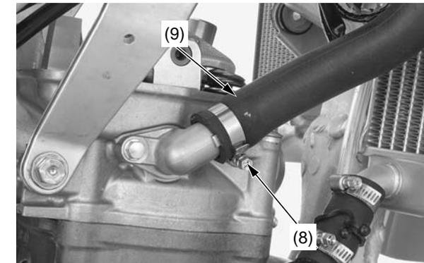
(8) tornillo de la abrazadera de la manguera del radiador
