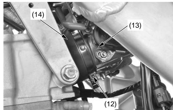
(12) tornillo de la banda del aislador
