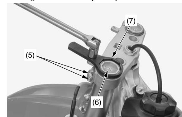
(5) pernos de fijación superiores del puente de la horquilla
