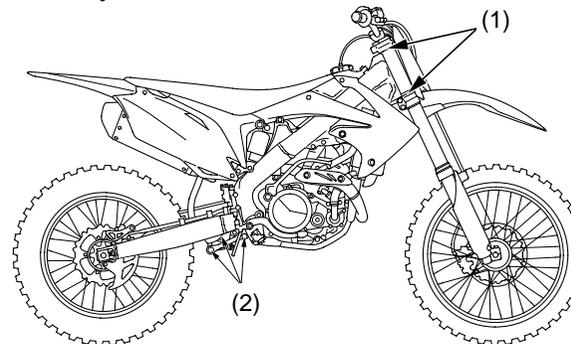
(1) cojinetes del cabezal de la dirección
