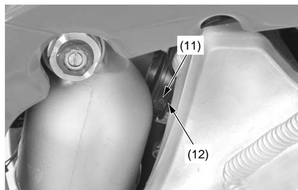
(11) lengüeta del tubo de conexión del filtro de aire
