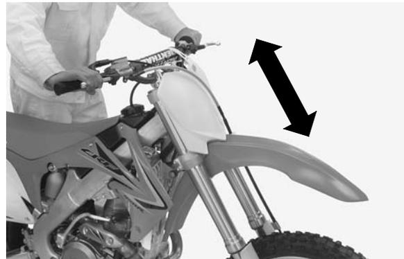
31. Mientras mantiene paralelas las horquillas, apriete alternadamente los pernos de fijación del eje derecho (34) a la torsión especificada:
