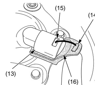
(13) cubierta de acoplamiento de conexión rápida de combustible
