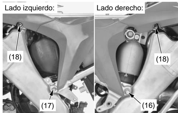
(16) perno inferior del bastidor secundario derecho
