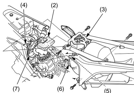
(2) ECM (6) tubo de conexión del filtro de aire
