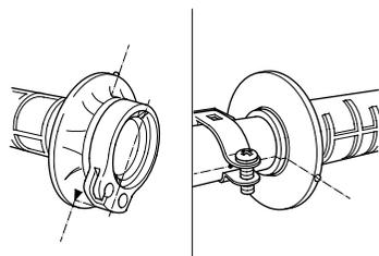
Para mayor seguridad, podrá unir con alambres de seguridad las empuñaduras al manillar y al tubo del acelerador para evitar la posibilidad de aflojamiento. Coloque los extremos trenzados del cable apartados de sus palmas de las manos y asegúrese de doblar bien los extremos del cable en la goma de las empuñaduras para que no le raspen los guantes.
