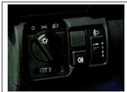
En un automóvil se usa para regular la intensidad luminosa del tablero de instrumentos, el volumen de la radio o la velocidad del ventilador de aire del habitáculo.
