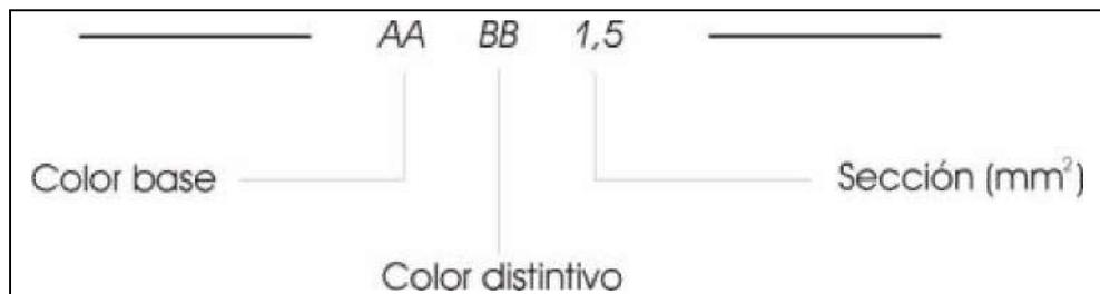
La codificación del color de los cables la suele dar cada fabricante al principio del manual. Esta codificación suele corresponder a la primera o primeras letras del nombre del color (según el idioma, lógicamente). A continuación se ven varios ejemplos, según distintos fabricantes:
