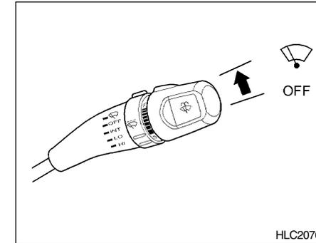
Si desea utilizar un solo limpiaparabrisas para eliminar el vaho, levante la palanca de control del líquido limpiador y del limpiaparabrisas.
