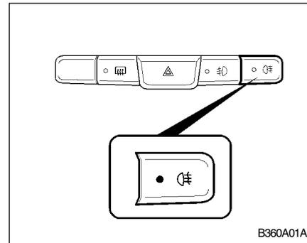
Para encender las luces antiniebla traseras, pulse el interruptor. Se encenderán cuando el interruptor de los faros esté en la segunda posición y la llave esté en la posición "ON".
