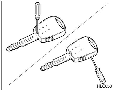
1. Retire el tornillo con un destornillador (+).
