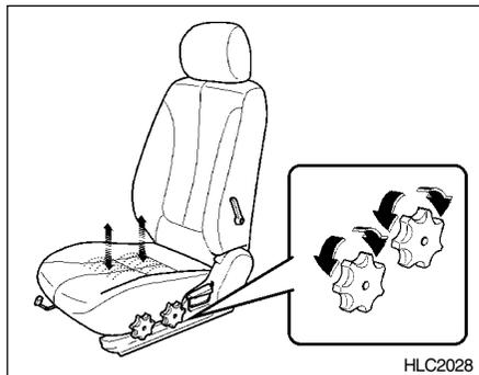
Si éste viene instalado, para ajustar la altura, deberá girar la rueda situada en el costado delantero izquierdo del cojín del asiento. Girándola en el sentido de giro del reloj, subirá la parte delantera del cojín, para bajarla debe girarla en sentido opuesto.
