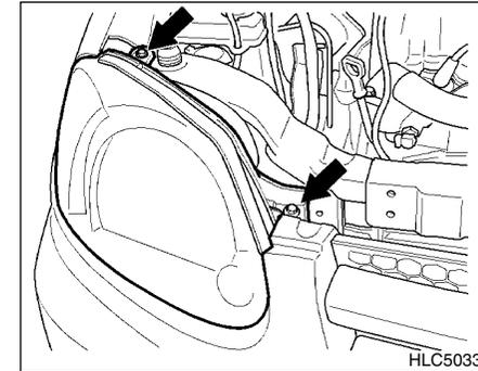
4. Retire los pernos de montaje del faro con una llave inglesa.
