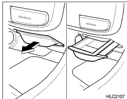
Éste se puede abrir tirando de su tapa. Para sacarlo y poderlo limpiar, presione el gancho de fijación y extraigalo. Para volver a instalarlo debe mantener apretado el gancho de fijación mientras lo introduce.
