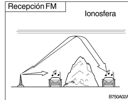
La recepción de las señales de AM normalmente es mejor que las de FM. Esto se debe a que las señales AM son transmitidas en ondas de baja frecuencia. Estas ondas largas y de baja frecuencia pueden seguir la curvatura de la tierra, a través de la atmósfera, reflejándose en la ionosfera. Esto permite que estas ondas puedan cubrir mayores áreas,
