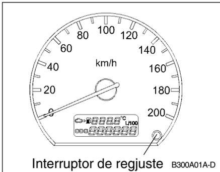
Su HYUNDAI tiene un velocímetro calibrado en kilómetros por hora o millas por hora.
