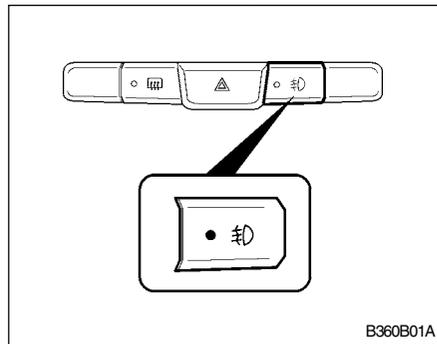
Para encender los faros antiniebla delanteros, pulse el interruptor a la posición "ON". Se encienden cuando los faros delanteros estén encendidos en la primera o segunda posición.
