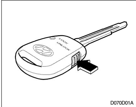
El sistema se desactiva al desbloquear la puerta del conductor o del acompañante pulsando el transmisor después de haberlo activado.
