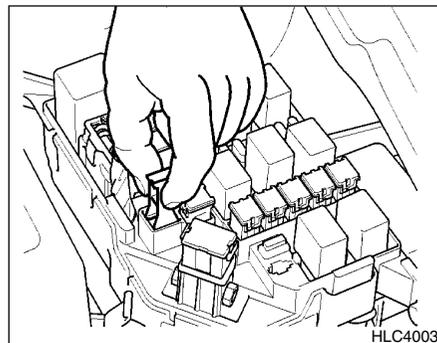
4. Cambie el fusible, poniendo uno nuevo del mismo rango en lugar del quemado. En la caja de fusibles encontrará fusibles de reemplazo, de no ser así recurra a su Servicio HYUNDAI. Si usted no tiene un fusible de recambio puede sacarlo
