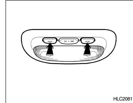
Los dos interruptores de la luz están situados a ambos lados de la consola central superior. Presione sobre cualquiera de los extremos de estos interruptores para realizar su encendido o apagado.
