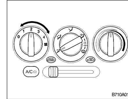
Para el normal uso de la calefacción, coloque el selector de entrada de aire en la posición
