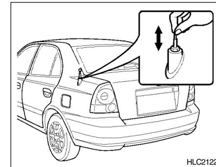
Su automóvil esta equipado con una antena de acero inoxidable para recibir las señales de las emisoras de radio en AM y FM. Para levantar la antena emplee sus dedos, como se muestra en el dibujo.
