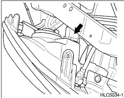
5. Desconecte el cable de la base de la bombilla situado en la parte trasera del faro.
