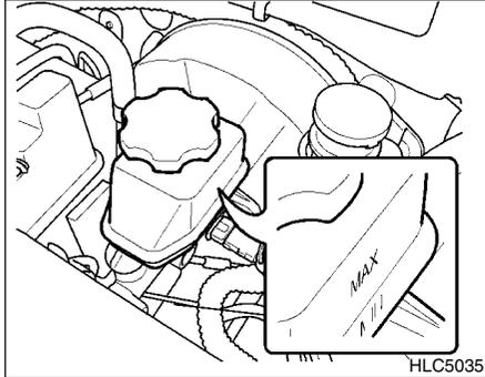
El nivel de líquido de frenos debe ser controlado periódicamente. El nivel debe estar entre las marcas "MIN" y "MAX" indicadas al lado del depósito. Si el nivel es inferior al "MIN" debe rellenar con líquido, hágalo con cuidado. No rellene más de lo indicado.
