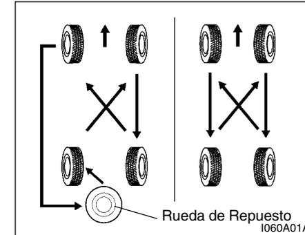
Los neumáticos deben ser rotados cada 10000 Km (6000 millas). Si usted ve que los neumáticos se están desgastando en forma incorrecta entre cada rotación, el automóvil debe ser verificado por su Servicio HYUNDAI para que sea reparado. Después de la rotación, ajuste la presión de los neumáticos a los rangos adecuados y asegúrese de que los tornillos estén adecuadamente apretados.
