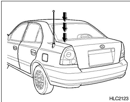
La antena se extenderá automáticamente cuando usted encienda la radio; la llave de contacto debe estar en "ACC" o "ON". La antena se retraerá cuando usted apague la radio o coloque la llave de contacto en "LOCK".
