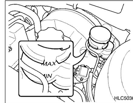
El líquido del embrague en el cilindro maestro, deberá ser una parte de las revisiones que se hacen en el compartimiento del motor. Además, deberá revisarse si en el sistema pudiera existir alguna fuga al mismo tiempo. Revise cuidadosamente que el nivel del líquido en el depósito, se encuentra entre "MAX" y "MIN". El depósito deberá llenarse según se requiera y si se vacía rápidamente, es que existe una fuga en el sistema, el cual deberá ser revisado y reparado de inmediatamente.
