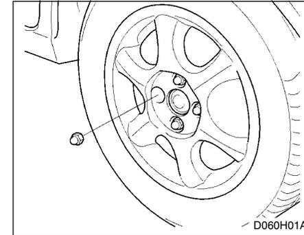
Para instalar los tapacubos, sujételas en la rueda y luego ponga las tuercas en los espárragos y apriételas con los dedos. Las tuercas deben instalarse con el menor diámetro hacia el interior. Mueva la rueda para asegurarse que está debidamente asentada, luego reapriete las tuercas con los dedos de nuevo.
