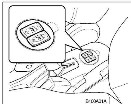
Se ha instalado un calefactor del asiento para calentar los mismos en condiciones ambientales frías. Gire la llave de encendido a la posición "ON" y pulse uno de los interruptores en el tablero trasero para calentar el asiento del conductor o el del acompañante.
