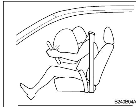
Ambos módulos de Airbag están ubicados en el centro del volante de dirección y frente al acompañante en el panel. Cuando el SRSCM detecta un impacto fuerte en la parte frontal del vehículo, automáticamente desplegará el Airbag.
