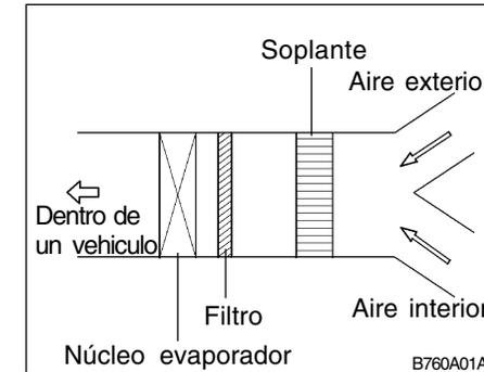
El filtro del aire se encuentra delante de la unidad del evaporador, detrás de la guantera.
