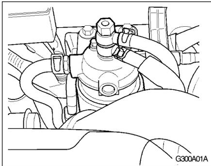
Si el testigo de advertencia del filtro de combustible se ilumina mientras conduce, significará que se ha acumulado agua en el filtro. En tal caso, extraiga el agua tal y como se describe a continuación:
