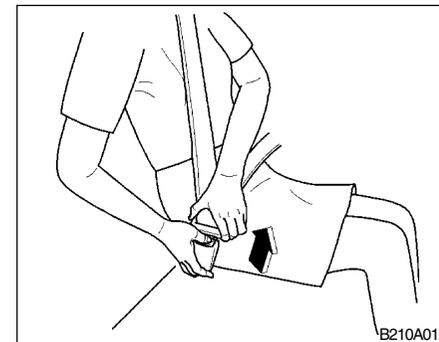
El cinturón puede soltarse, apretando el botón rojo del mecanismo de fijación en el centro del automóvil. Cuando éste se suelta, vuelve automáticamente a su posición original. Si esto no ocurre, verifique que el cinturón no está torcido, e inténtelo de nuevo.
