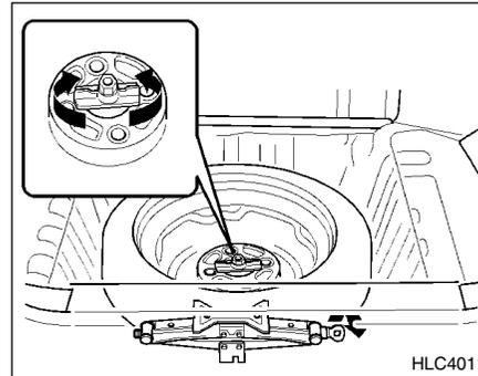
Saque la tuerca de fijación para poder sacar la rueda de repuesto. Para colocar la rueda de repuesto, que está en el compartimento de repuesto, apriete firmemente la tuerca de fijación con sus dedos, hasta que no tenga juego.
