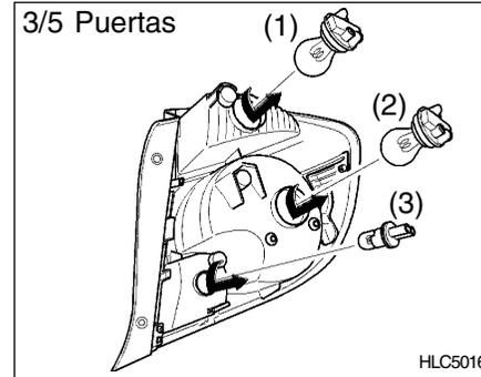
3. Para cambiar una bombilla del piloto trasero combinado (luz de freno y de posición, intermitente o luz de marcha atrás), extráigala del soporte girándola en sentido antihorario.
