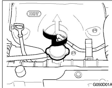
4. Gire la tapa del radiador en sentido antihorario sin ejercer presión sobre la misma hasta llegar al tope. De este modo se libera la presión residual del sistema refrigerante. Extraiga la tapa presionándola hacia abajo y girándola en sentido antihorario. Llene el radiador con agua limpia desmineralizada o agua destilada. Siga vertiendo pequeñas cantidades de agua limpia desmineralizada o agua destilada hasta que el nivel del líquido alcance el tubo de alimentación del radiador.
