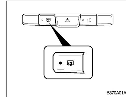
El descongelador de la luna trasera se conecta presionando el interruptor. Para calentar el cristal del espejo lateral exterior, apriete el botón "ON". El cristal del espejo lateral se calentará descongelándose o desempañándose.
