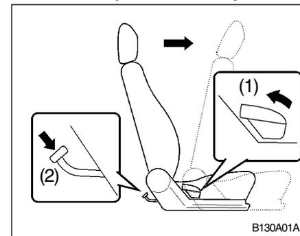
Para poder acceder al asiento trasero, el respaldo de los asientos del conductor y del acompañante deben estar inclinados.
