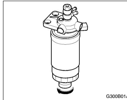
1. Afloje el obturador de drenaje de la parte final del filtro.
