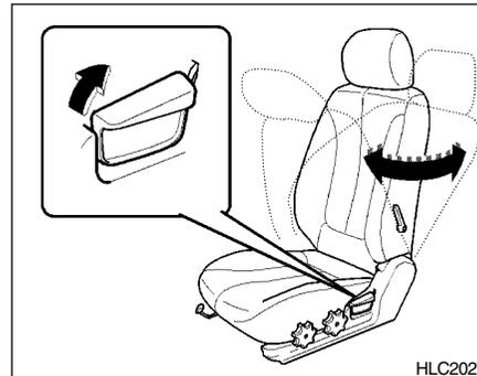
Para poder ajustar la inclinación del respaldo, usted debe inclinar su cuerpo ligeramente, de manera que el peso de la espalda no este contra el respaldo, en ese momento usted levanta la manilla que esta en la esquina del asiento, con la otra mano mueve el respaldo al ángulo deseado,
