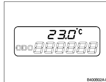
Este modo indica la temperatura exterior entre -40°C y 80°C.
