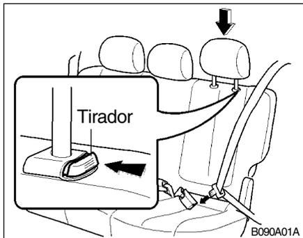
El diseño de los reposacabezas ayuda a reducir el riesgo de lesiones de cuello. Para elevar el reposacabezas, tire de él hacia arriba. Para bajarlo, empuje hacia abajo mientras presiona el tirador.
