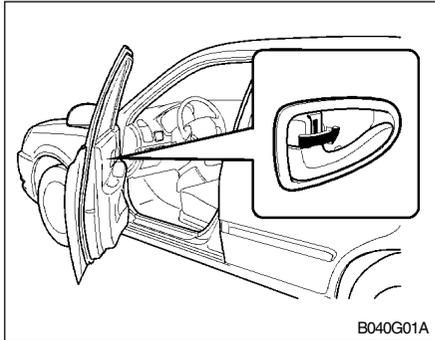
El bloqueo central de puertas delanteras y traseras es accionando pulsando el interruptor del conductor. Si la puerra del acompafiante o las traseras están abiertas cuando sea accionado el interruptor las puertas permanecerán bloqueadas tan pronto como sean cerradas.
