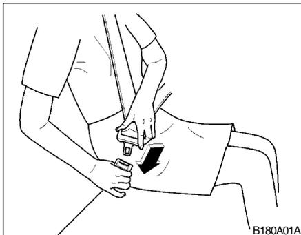
Para abrochar su cinturón, tire de él para que éste salga del sistema de retracción e inserte la parte metálica en el cierre de fijación. Sentirá un "click" cuando el mecanismo se haya asegurado. El cinturón automáticamente se ajustará al largo adecuado. Si usted desplaza su tronco suavemente hacia adelante, el cinturón se extenderá junto con su desplazamiento, pero si usted hace un movimiento brusco éste se
