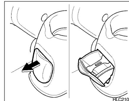
El cenicero trasero se puede sacar tirando del borde superior. Para sacar el cenicero vaciarlo y limpiarlo tirar hacia fuera y hacia arriba.
