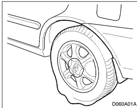
El procedimiento que se describe en las próximas páginas, puede utilizarse tanto para rodar las ruedas como para cambiarlas, cuando haya una pinchada. Cuando se prepare para cambiar una rueda pinchada, compruebe que la palanca está en "P" (A/T) o marcha atrás (mecánica) y el freno de mano puesto, entonces:
