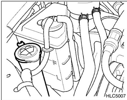
El depósito limpiaparabrisas proporciona agua para lavar los parabrisas. Se debe poner un líquido de buena calidad en el depósito. El nivel debe ser verificado de forma más constante cuando existe mal tiempo o cuando este sistema se emplea muy seguidamente. La capacidad del depósito de reserva es de 3,0 litros (3,1 U.S. cuartos).
