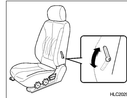
El asiento delantero del conductor en algunos HYUNDAI está equipado con un soporte ajustable. Para aumentar el soporte lumbar debe girarse la manilla, que está ubicada en el costado derecho del respaldo, hacia adelante. Para disminuirlo, debe girarse en sentido opuesto.
