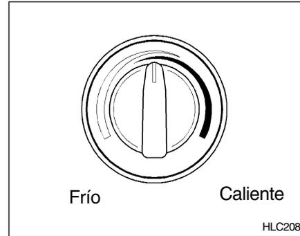
Este es empleado para conectar y seleccionar el rango de temperatura deseado.
