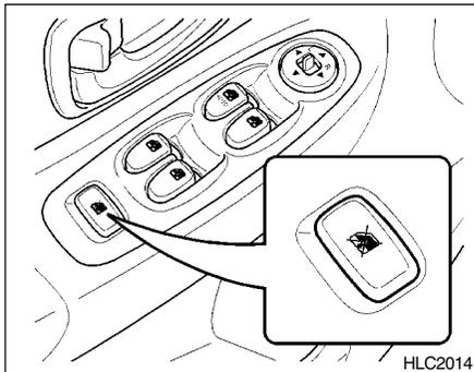
Para evitar que se abran las ventanas, en el apoyabrazos de la puerta del conductor se encuentra un interruptor de bloqueo de las lunas. Para desactivar el elevalunas eléctrico, pulse el interruptor de bloqueo de las lunas.
