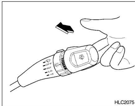
Para utilizar el lavaparabrisas, tire de la palanca del limpiaparabrisas junto al volante de dirección. Cuando el lavaparabrisas está operando, el limpiaparabrisas automáticamente realiza dos pasadas sobre el parabrisas. El lavaparabrisas continúa operando hasta que se suelte la palanca de mando.
