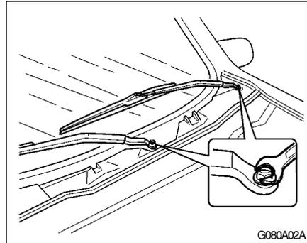
Las plumillas limpiaparabrisas deben ser inspeccionadas de vez en cuando y limpiadas para sacar la película de polvo y suciedad acumulada. Para limpiarlas debe emplear una esponja con agua limpia y jabón. Si las plumillas dejan surcos o manchas en los parabrisas, reemplácelas por piezas originales HYUNDAI.
