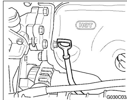
Antes de revisar el nivel de aceite, debe calentar el motor a la temperatura normal de operación, vea que está estacionado en una superficie plana y nivelada. Pare el motor.
