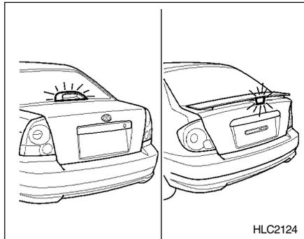
Además de las luces traseras indicadoras de frenado, montadas a ambos lados en la parte inferior del vehículo, puede instalarse otra luz en la mitad de la parte superior de la ventana trasera o en el alerón posterior que se ilumina con la finalidad de comunicar a los demás conductores que el vehículo está frenando.
