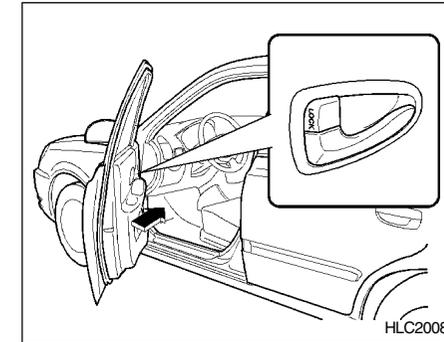
Las puertas pueden ser bloqueadas desde el exterior sin necesidad de utilizar una llave. Para bloquear las puertas desde el exterior, sitúe el interruptor interior de bloqueo en la posición "LOCK" (cierre), de manera que la marca roja del interruptor no sea visible, y seguidamente cierre la puerta.
