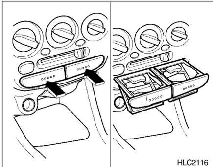
El soporte para bebidas delantero se encuentra en el panel central delantero, y tiene la función de sujetar vasos o latas. El soporte puede ser utilizado tirando de él.
