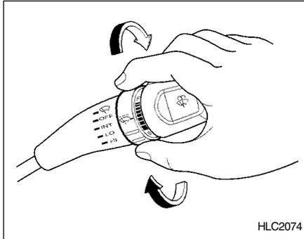
Para utilizar la capacidad de intermitencia de los limpiaparabrisas sitúe la palanca selectora en la posición "INT". En esta posición se puede ajustar la frecuencia de trabajo entre 1 y 18 segundos, moviendo el interruptor de regulación. Éste también varía automáticamente en función de la velocidad.
