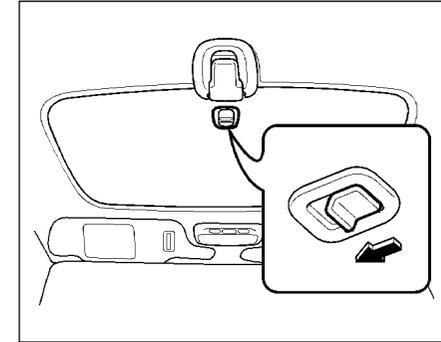
1. Tirar de la palanca hacia la parte delantera del parasol, después tirar hacia abajo de la parte trasera del parasol.
