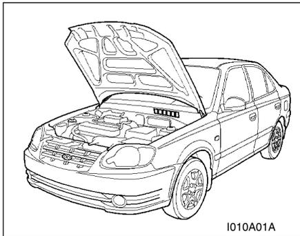
El número de identificación del vehículo (VIN) es el número usado para registrar su vehículo y necesario en todas las instancias legales concernientes, como propiedad del mismo, etc. Éste se puede encontrar en la placa de identificación colocada en el compartimento del motor, adherida al panel entre el motor y el compartimento de los pasajeros.
