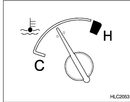
La aguja del indicador de temperatura del líquido refrigerante deberá permanecer en la zona normal. Si se mueve a la zona señalada con "H" (caliente) del indicador, desvíese a la derecha, deténgase y pare el motor tan pronto como sea posible. Si sospecha que existe un problema en su sistema de refrigeración, haga que sea inspeccionado urgentemente por su Servicio Oficial Hyundai.
