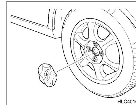
4. Instale de nuevo el tapacubos montando el saliente de anclaje del tapacubos en la ranura de la rueda, y golpee el centro del tapacubos con la mano.
