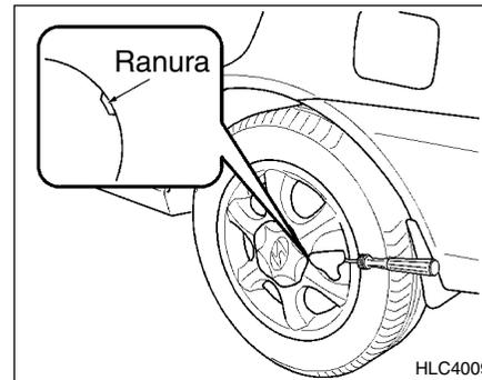
1. Envuelva la punta de un destornillador con un paño para evitar producir rayadas.
