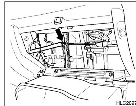
2. Retire el cable y el cableado de la tapa del filtro.
