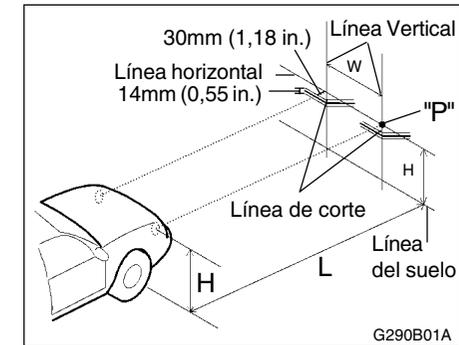
Si el vehículo ha sufrido una reparación del frontal de la carrocería y se ha sustituido el conjunto de faro, se debe comprobar la nivelación del faro usando la pantalla de nivelación, como se muestra en la ilustración. Encienda los faros. (Posición de cruce)
