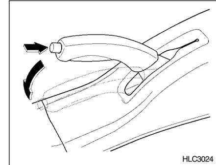
Siempre accione el freno de mano antes de bajar del vehículo. Esto encenderá el testigo de freno del tablero si la llave está en la posición "ON" o "START". Antes de empezar a conducir, asegúrese que freno de estacionamiento está completamente retirado, y el testigo está apagado.
