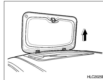
5. El techo solar puede retirarse con facilidad del panel del techo.
