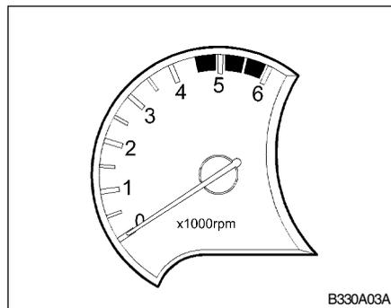
El tacómetro mide la velocidad del motor, en revoluciones por minuto (rpm). Es útil para determinar cual marcha de la caja de cambios es la más adecuada al regimen del motor, evitando sobrecargar el motor o sobre-revolucionarlo.
