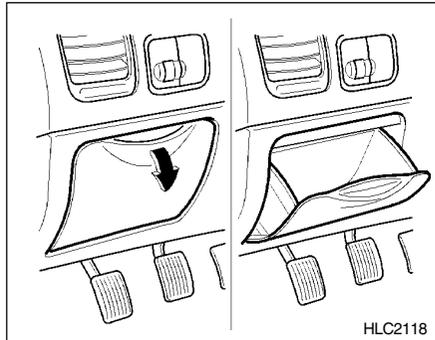
Al interior de la caja multifuncional se accede tirando hacia arriba de la palanca de apertura. Se usa para guardar otros objetos de tamaño similar.
