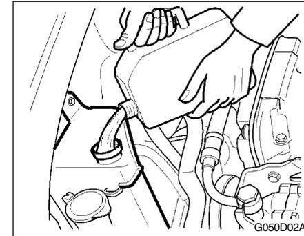
5. Arranque el motor, rellene el radiador hasta el tope, y añada agua hasta que el nivel del líquido del depósito igualador se sitúe entre las marcas "LOW" y "FULL".
