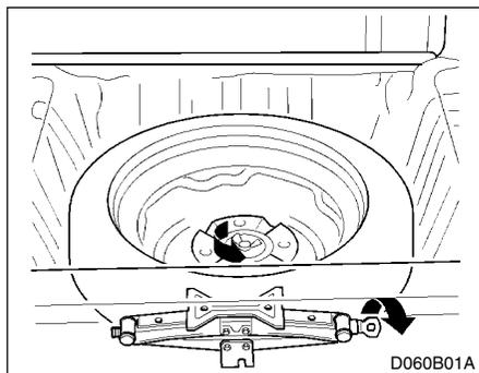
Saque el neumático de repuesto, el gato y la bolsa de herramientas del maletero.
