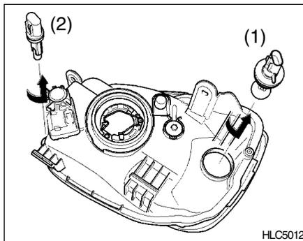
2. Para cambiar la bombilla del intermitente delantero (1) o de la luz de posición (2), extráigala del soporte girándola en sentido antihorario.
