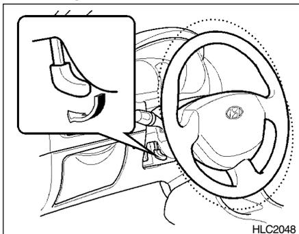
1. Tire de plancha hacia abajo para desbloquear el volante.
