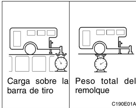
La carga sobre la barra de tracción se aumenta o disminuye repositando los diferentes objetos transportados por el remolque. Ello se comprueba pesando el remolque con su carga completa y comprobando después la carga sobre su barra de tracción.
