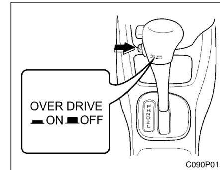
Cuando el interruptor de overdrive se pulsa, la caja de forma automática pasará desde 2ª a 3ª y overdrive (4ª). Cuando el interruptor de overdrive es desconectado la caja no cambiará a overdrive (4ª), solo llegará a 3ª. Para una conducción normal el selector de cambio deberá estar en "D" y el interruptor de overdrive encendido. Para mover la palanca de cambio, deberá apretar el botón de seguro.
