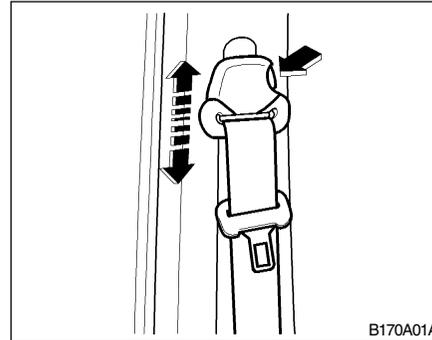
El anclaje del cinturón de seguridad en el hombro puede regularse a 4 posiciones de altura.
