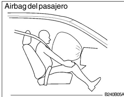
Después del inflado por completo, el Airbag comienza inmediatamente a desinflarse permitiendo al conductor obtener una mayor visibilidad y la posibilidad de conducir el vehículo.
