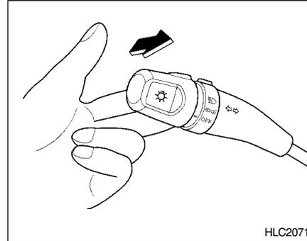
Si se acciona la palanca del mando selector de luces hacia arriba y luego se suelta, obtendrá un destello de las luces largas. Pueden hacerse ráfagas con los faros aunque el interruptor de los mismos se encuentre en posición de "apagado".
