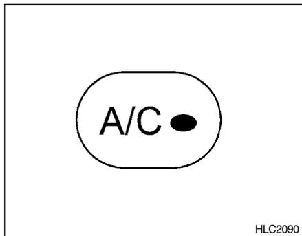
El aire acondicionado es conectado presionando el interruptor A/C en el panel de control de calefacción/ aire acondicionado.
