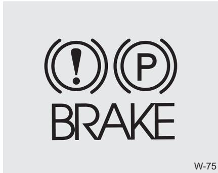
Compruebe el piloto de aviso de freno girando la llave de contacto a la posición ON (sin arrancar el motor). Este piloto se iluminará siempre que se aplique el freno de estacionamiento mientras el contacto está en las posiciones START u ON.
