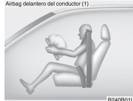
Los módulos de airbag se encuentran en el centro del volante y en el panel del acompañante, por encima de la guantera. Cuando el SRSCM detecta un impacto frontal suficientemente fuerte, despliega automáticamente los airbags delanteros.
