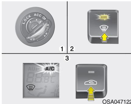
Si se ha descargado o desconectado la batería, se reiniciará con el estado de la lógica de desempañado.
