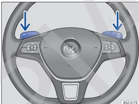
**Fig. 104** Volante con dos levas para cambiar de marcha en modo manual.
