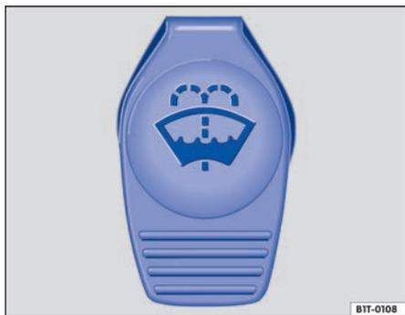
Fig. 69 En el compartimento del motor: tapa del depósito de agua de los lavavidrios.
