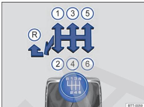
Fig. 98 Esquema de la transmisión manual de 6 marchas.
