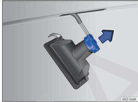
**Fig. 176** Luz de la placa de licencia: desmonte el portalámpara de la lámpara.
