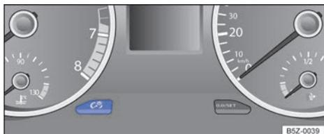
**Fig. 62** En el panel de instrumentos: tecla de regulación de la iluminación de los instrumentos y de los interruptores.
