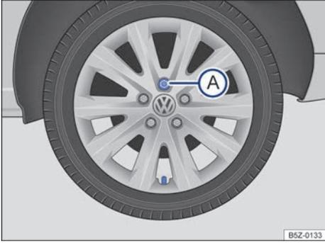
Fig. 159 Retire el tapacubos integral.
