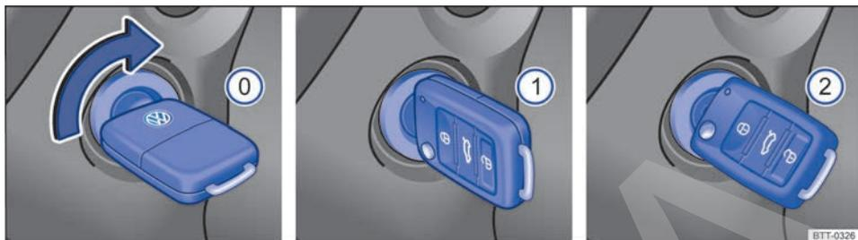
Fig. 93 Al lado del volante, a la derecha: posiciones de la llave del vehículo en la cerradura de encendido.
