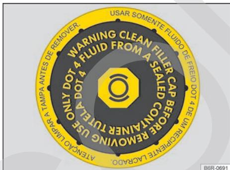
**Fig. 110** En el compartimento del motor: tapa del depósito del líquido de freno.
