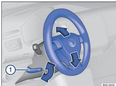
Fig. 42 Ajuste de la posición del volante mecánicamente.
