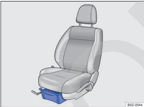
**Fig. 83** Cajón debajo del asiento del conductor: portaobjetos.
