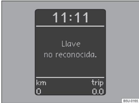
**Fig. 94** En el panel de instrumentos: display con indicación del inmovilizador activado - vehículos con Sistema de Informaciones Volkswagen.
