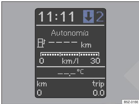
**Fig. 99** En el panel de instrumentos : indicador de cambio de marcha (variante 1).
