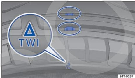
Fig. 139 Perfil del neumático: indicador de desgaste.
