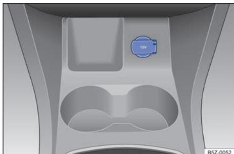
Fig. 91 En la consola central delantera: toma de corriente de 12 V.
