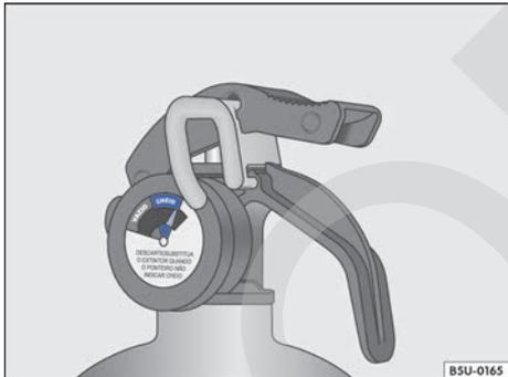
Fig. 148 En el extintor: indicador de carga (manómetro).
