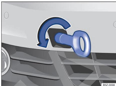
**Fig. 180** En el paragolpes delantero a la derecha: enrosque la argolla para remolque.
