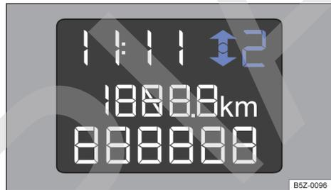
**Fig. 100** En el panel de instrumentos : indicador de cambio de marcha (variante 2).
