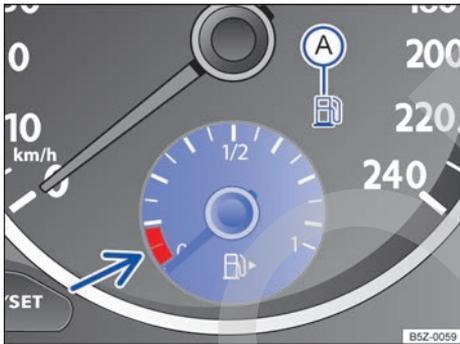
**Fig. 123** En el panel de instrumentos: indicador del nivel de combustible.
