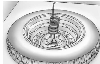
14. Incline el retén de llanta que se encuentra en el extremo del cable y tire de él a través de la abertura de la rueda. Tire de la llanta para sacarla de debajo del vehículo.
