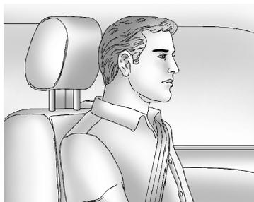
Ajuste el reposacabezas de tal forma que la parte superior del mismo esté a la misma altura que la parte superior de la cabeza del ocupante. Esta posición reduce la probabilidad de una lesión de cuello durante un accidente.
