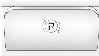
Para quitar el freno de estacionamiento, mantenga presionado el pedal del freno regular. Para liberar el freno de estacionamiento, tire directamente hacia atrás del borde inferior de la palanca que tiene el símbolo del freno de estacionamiento, que se encuentra arriba del pedal del freno de estacionamiento.
