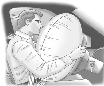
La bolsa de aire del conductor se encuentra en la parte central del volante.
