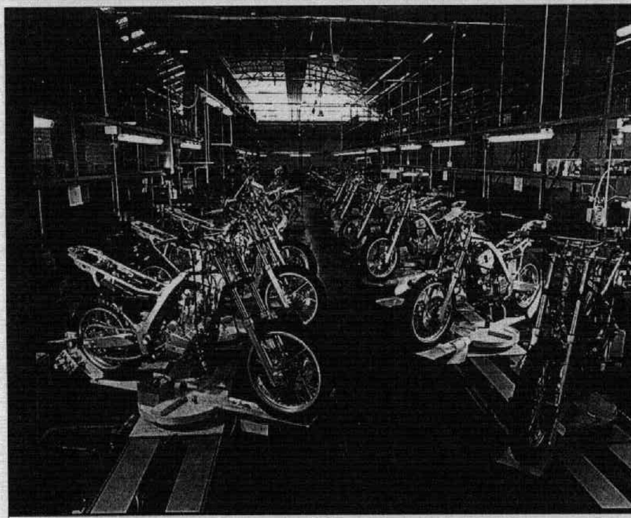
Vista de conjunto de la cadena de montaje de la BMW F 650 en los talleres de Aprilia.
