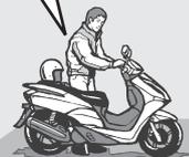
Estacione en una superficie firme y nivelada. Utilice el caballete, bloquee la dirección y cierre el obturador.
