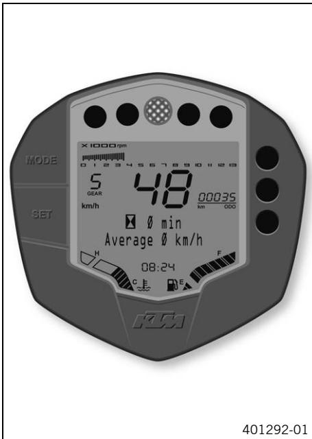
El nivel de llenado se visualiza en el display mediante 9 barras. Cuanto más barras estén iluminadas mayor será el nivel de combustible en el depósito de combustible.
