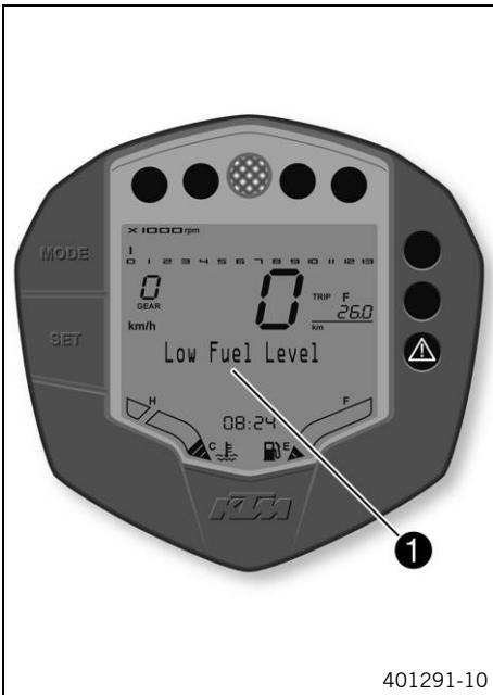
En el display de información ① se visualizan distintas advertencias. Cuando se ilumina el testigo de aviso general ④, en el display de información se muestra el aviso correspondiente.
