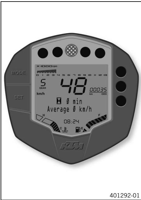
El indicador de temperatura se visualiza en el display mediante 13 barras. Cuanto más barras se iluminan más caliente está el refrigerante. Adicionalmente, cuando se iluminan todas las barras en el display de información también se muestra el aviso **High Coolant Temperature**.
