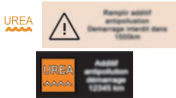
Al poner el contacto, el testigo UREA se enciende acompañado de una señal sonora y de la indicación de un mensaje (por ejemplo: "Llene con aditivo anticontaminación: Arranque prohibido en 1 500 km") indicando la autonomía de circulación expresada en kilómetros o millas.
