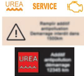
Cada vez que se ponga el contacto, los testigos SERVICE y autodiagnosis motor se encenderán y el testigo UREA parpadeará, acompañados de una señal sonora y de la indicación del mensaje "Fallo anticontaminación: Arranque prohibido".
