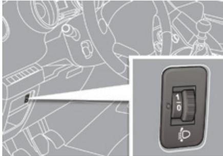
Para no molestar a los demás usuarios de la vía, debe regularse la altura de los faros con lámparas halógenas, en función de la carga del vehículo.
