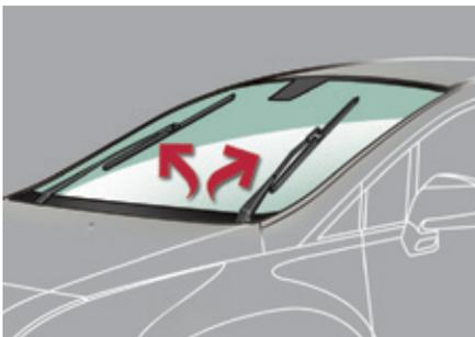
Esta posición permite separar las escobillas del parabrisas delantero.
