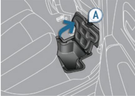
Según la configuración, el vehículo está equipado con unos espacios de almacenamiento bajo los pies, situados delante de los asientos traseros laterales. Puede accederse a ellos mediante las trampillas, dotadas cada una de ellas de una empuñadura de agarre **A**.
