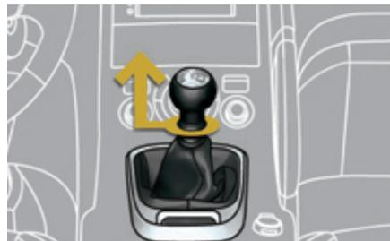
☞ Levante el anillo situado bajo el pomo y desplace la palanca de cambios hacia la izquierda y luego hacia adelante.
