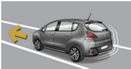
**En una subida, con el vehículo parado, este se mantiene un momento después de soltar el pedal del freno:**
