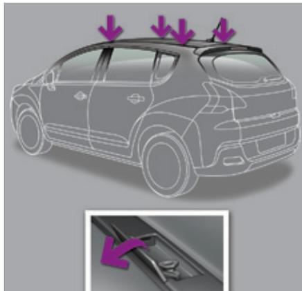
Para instalar las barras de techo transversales, utilice las cuatro fijaciones rápidas previstas para ello:
