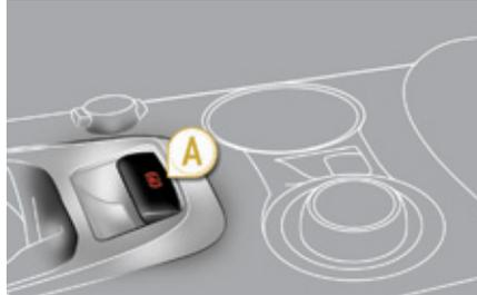
En caso de fallo de la frenada mediante el pedal del freno o en situaciones excepcionales (por ejemplo: malestar del conductor, conducción acompañada, etc.) **tirar de forma continua del mando A permite detener el vehículo.**
