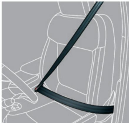
Los cinturones de seguridad delanteros están equipados con un sistema de pretensión pirotécnica y con limitador de esfuerzo. Este sistema mejora la seguridad en las plazas delanteras durante los choques frontales y laterales. En función de la importancia del choque, el sistema de pretensión pirotécnica tensa instantáneamente los cinturones contra el cuerpo de los ocupantes.
