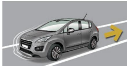
**En una bajada, con el vehículo parado y la marcha atrás introducida, el vehículo se mantiene un momento después de soltar el pedal del freno.**
