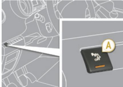
☞ Pulse el botón **A**. El testigo se enciende y el sistema queda totalmente neutralizado.
