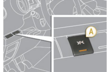
Puede activar la función de medición de plaza disponible pulsando el mando **A**. El encendido fijo del testigo indica la selección de la función.
