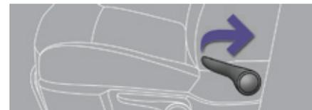
**!** Antes de desplazar el asiento hacia atrás, compruebe que nada ni nadie impida el movimiento del asiento hacia atrás, para evitar cualquier riesgo de pinzamiento o de bloqueo del asiento debido a la presencia de objetos voluminosos situados en el suelo detrás del asiento o a la presencia de pasajeros traseros. En caso de bloqueo, interrumpa inmediatamente la maniobra.
