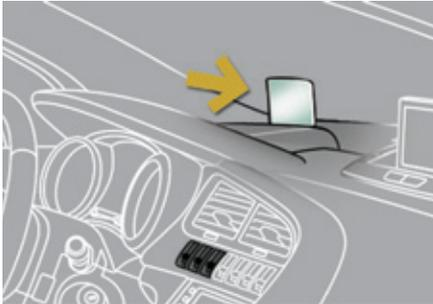
Sistema que proyecta un conjunto de datos en una lámina transparente, en el campo de visión del conductor para que este no tenga que apartar la vista de la carretera. Este sistema funciona con el motor en marcha y conserva los reglajes al cortar el contacto.
