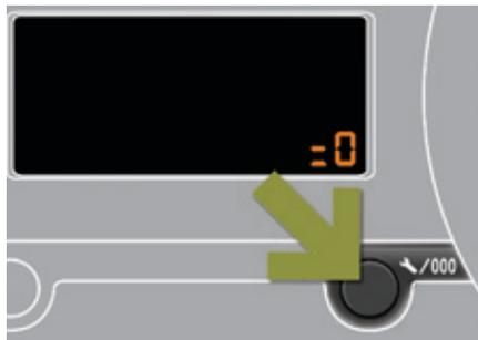
Después de cada revisión, debe poner a cero el indicador de mantenimiento.
