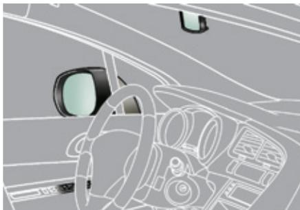
Cada uno de ellos está equipado con un espejo regulable, que permite la visión trasera lateral necesaria para las situaciones de adelantamiento o estacionamiento. Los retrovisores pueden plegarse para estacionar en lugares estrechos.
