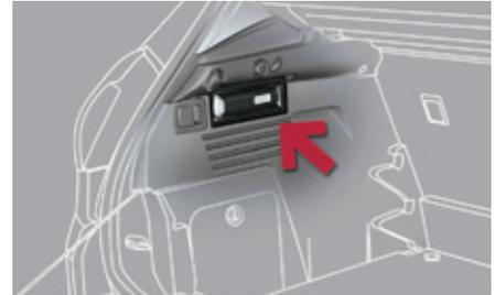
Luz portátil integrada en la pared del maletero que se puede utilizar para iluminar el maletero y como linterna.
