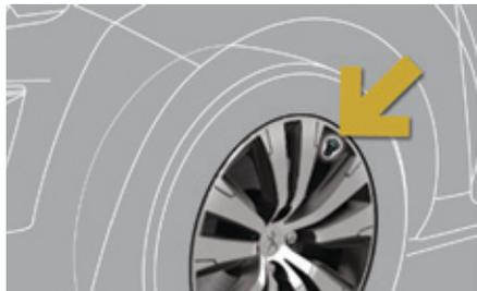
Sistema que controla automáticamente la presión de los neumáticos durante la circulación.
