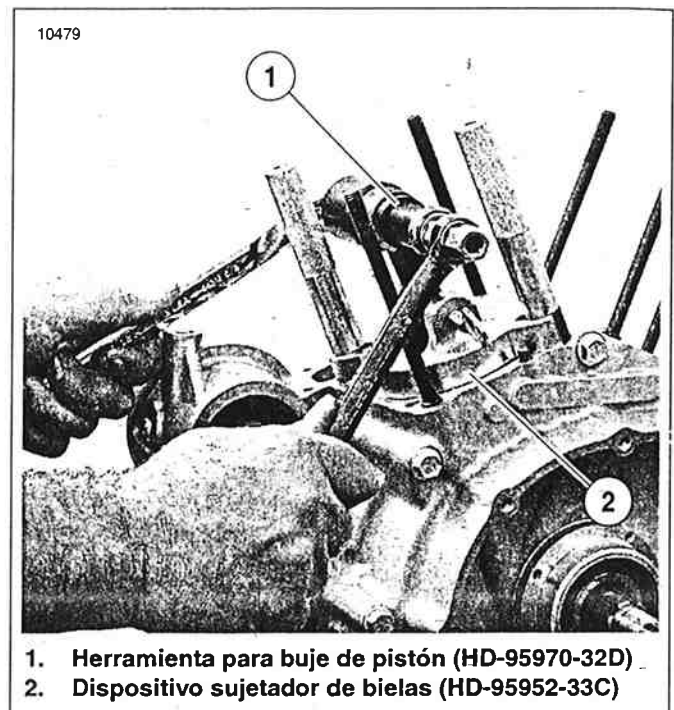
Figura 3-59. Instalación de un buje de pasador de pistón nuevo
