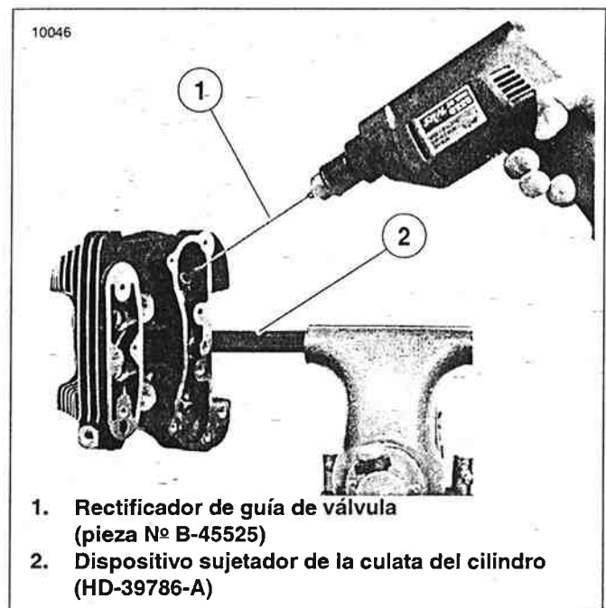
Figura 3-39. Escariado del diámetro interior de la guía de la válvula
