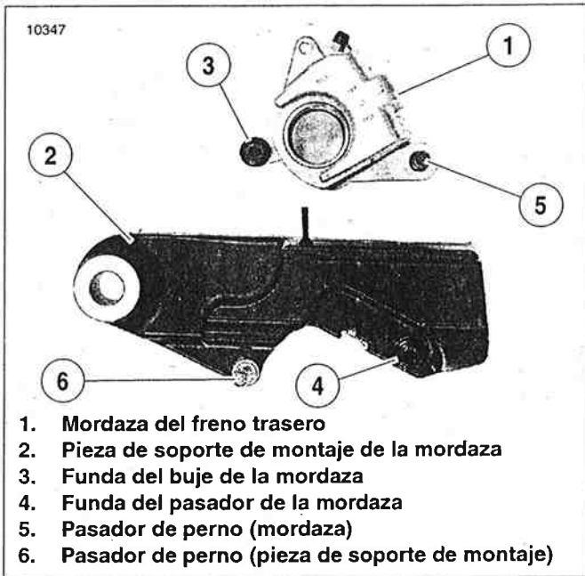
Figura 2-117. Lubricación de las fundas y pasadores de la mordaza
