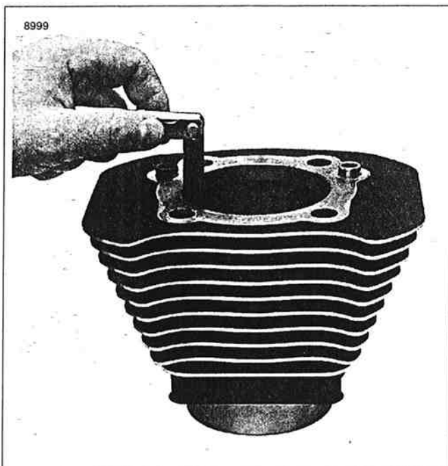
Figura 3-51. Medición del espacio libre del extremo de los anillos
