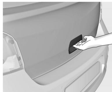
Después del desbloqueo, pulse el botón situado bajo la manilla o debajo de la moldura del portón trasero y abra el portón trasero.
