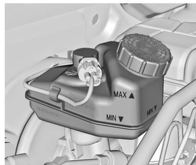
El nivel del líquido de frenos debe estar entre las marcas **MIN** y **MAX**.
