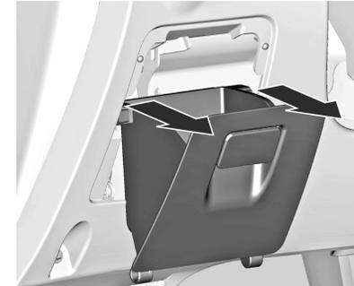
3. Desmonte el compartimento mediante las dos ranuras en la dirección de las flechas.
