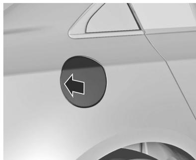
La tapa del depósito sólo se puede abrir con el vehículo desbloqueado. Desbloquee la tapa del depósito de combustible pulsando sobre la misma.
