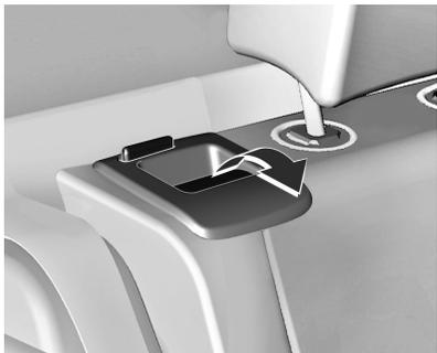
Tire de la palanca de desbloqueo en uno o ambos lados y abata los respaldos sobre la banqueta de asiento.
