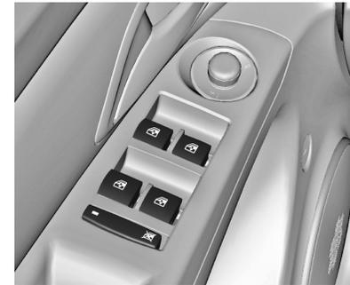
Pulse el interruptor
