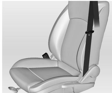
En caso de colisiones frontales y traseras, a partir de una determinada gravedad, se tensan los cinturones de seguridad delanteros.
