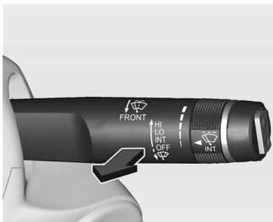
Tire de la palanca. Se pulveriza líquido de lavado sobre el parabrisas y los limpiaparabrisas se accionan durante varios ciclos.
