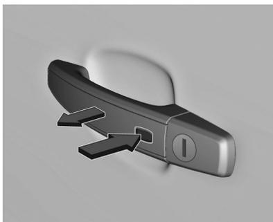
Pulse el interruptor en la manilla de la puerta para desbloquear el vehículo y tire de la manilla de la puerta para abrirla o pulse el botón debajo de la moldura de la tapa del maletero.
