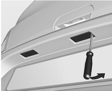
1. Inserte un destornillador en posición vertical en el portalámparas, presione hacia un lado y desbloquee el muelle.
