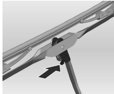
Levante el brazo del limpiaparabrisas. Mueva la palanca de desbloqueo y desacople la escobilla.
