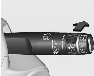
Presione la palanca. Se pulveriza líquido de lavado sobre la luneta trasera y el limpiavientos se realiza el barrido varias veces.
