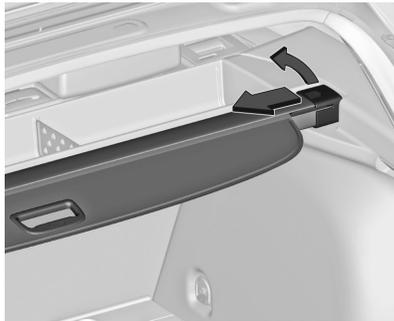
Abra la cubierta del compartimento de carga.
