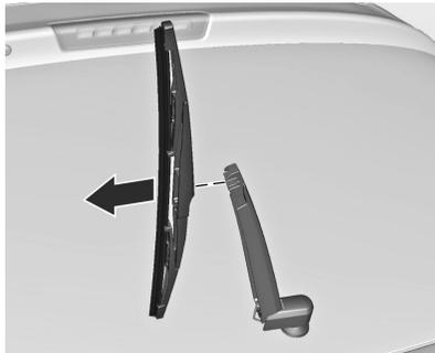
Levante el brazo del limpiavientos. Desacople la escobilla como se muestra en la ilustración y desmóntela.
