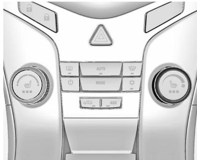
Gire el conmutador giratorio derecho. La velocidad del ventilador seleccionada se indica mediante el número en la pantalla.
