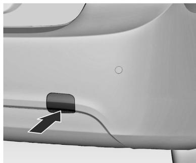
Desenclave la tapa por abajo y retírela hacia abajo. La argolla de remolque se guarda con las herramientas del vehículo ↪ 211.
