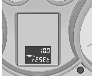
Pulse el mando de reinicio durante unos 5 segundos hasta que se haya mostrado la vida útil restante del aceite del motor. Suelte el mando de reinicio y púlselo de nuevo unos segundos para reiniciar el sistema de control de vida útil del aceite del motor.
