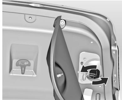
1. Retire el revestimiento de la tapa del maletero.
