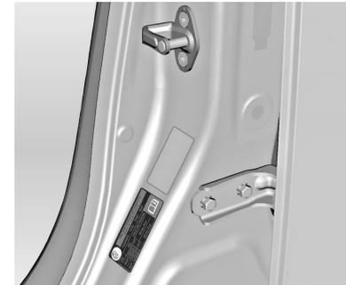
Presión de los neumáticos ⇄ 242 y en la etiqueta colocada en el marco de la puerta delantera izquierda.
