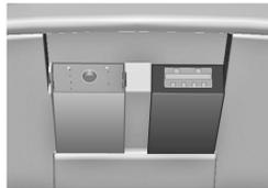
Debajo de la cubierta de la consola central hay un puerto USB para conectar fuentes de audio externas.
