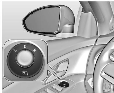
Seleccione el retrovisor exterior correspondiente girando el mando a la izquierda (**L**) o a la derecha (**R**). En la posición **0** no hay seleccionado ningún retrovisor.
