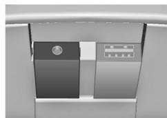
Debajo de la cubierta de la consola central hay una conexión AUX para conectar fuentes de audio externas.
