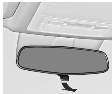
Ajuste la palanca en la parte inferior para reducir el deslumbramiento.
