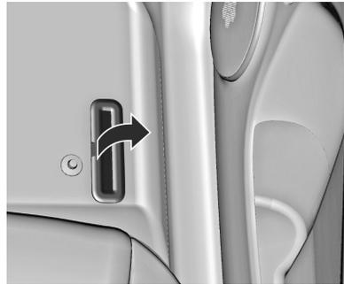
El número de identificación del vehículo está situado en el piso del vehículo, en el lado derecho, debajo de una tapa entre la puerta delantera y el asiento.
