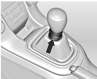
Marcha atrás: con el vehículo parado, desembrague y luego levante la anilla de la palanca selectora y engrane la marcha.
