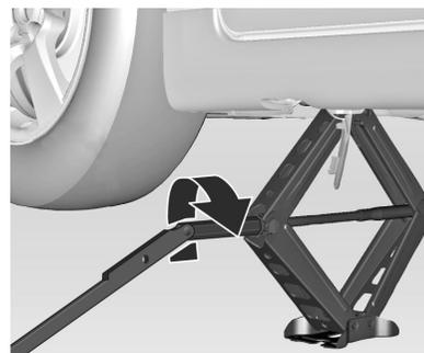
Acople la llave para ruedas y, con el gato correctamente alineado, gire la llave para ruedas hasta que la rueda se despegue del suelo.
