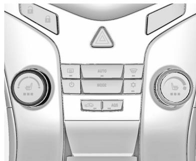
Ajuste la temperatura al valor deseado girando el mando.
