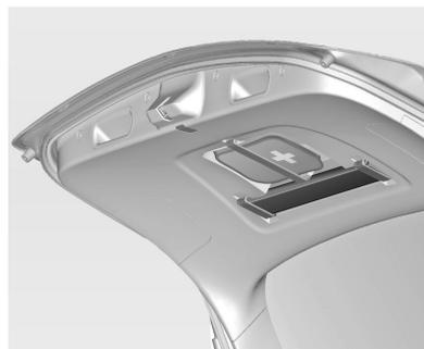
Pliegue las correas. Guarde el triángulo de advertencia en el espacio situado detrás de las correas, en el interior del portón trasero.
