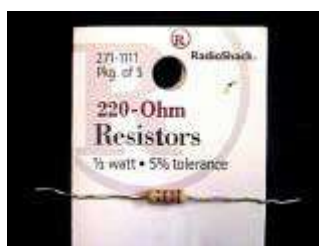
Una Resistencia de 220 ohms.
