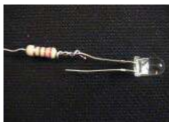
Resistencia conectada al positivo del LED
