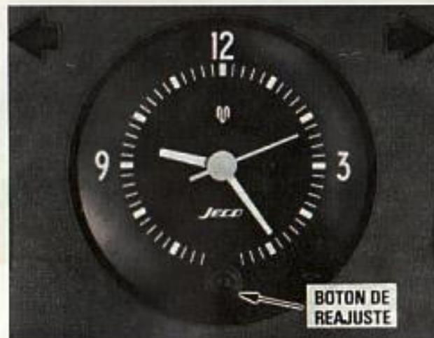
Para ajustar las manecillas del reloj, tire del botón y gírelo hacia la derecha para adelantar-lo y hacia la izquierda para retrasarlo.
