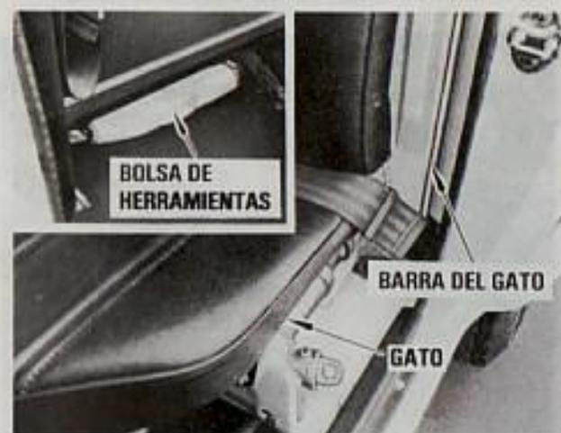
**MODELOS DE CABINA DOBLE:** Saque la bolsa de herramientas, el gato y la barra del gato de la cabina trasera.
