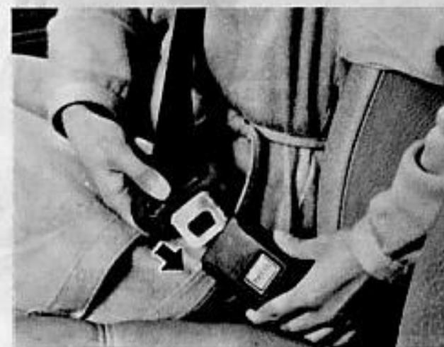
**Para ponerse el cinturón, sáquelo del todo del retractor e inserte la lengüeta en la hebilla.**
