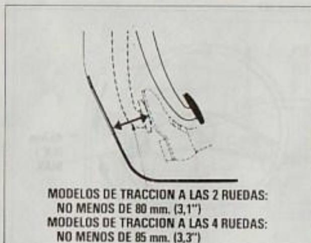
Con el motor en marcha, haga que alguien le apriete el pedal del freno varias veces y luego apriete duramente (con aproximadamente 50 kg.) sobre él. La distancia desde el piso a la superficie superior del pedal deberá ser menos que el límite.
