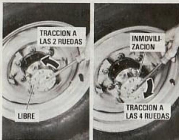
**Para la tracción a las 2 ruedas, coloque los cubos en "FREE" (LIBRE). Para la tracción a las 4 ruedas, coloque los cubos en "LOCK" (INMOVILIZACIÓN).**
