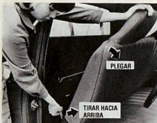
Tire de la palanca del respaldo hacia adelante: el respaldo se inclinará hacia adelante.
