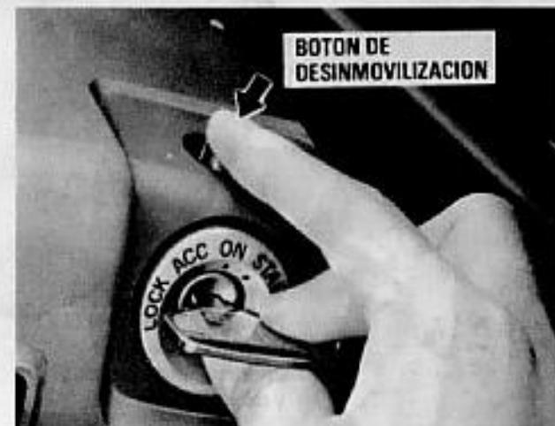
**"LOCK" (inmovilización) – El volante de dirección está inmovilizado. La llave se puede sacar solamente en esta posición.**
