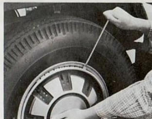
4. Usando el extremo del mango de la llave de bujías de encendido apalanque la cubierta de la rueda o el ornamento del cubo de la rueda, para sacarlos.
