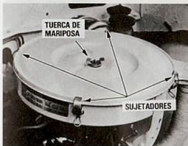
1. Para inspeccionar el elemento, desenrosque la tuerca de mariposa y suelte los sujetadores. Luego quite la cubierta y saque los elementos tirando hacia arriba.
