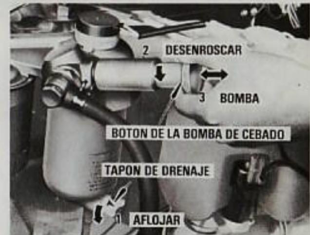
**Cuando se enciende la luz de aviso de nivel de agua del sedimentador, hay que drenar inmediatamente el agua del sedimentador.**
