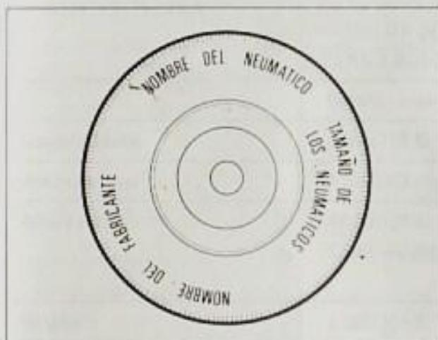
Quando cambie un neumático, use solamente el mismo tamaño y construcción que el instalado originalmente y con una capacidad de carga igual o mayor.
