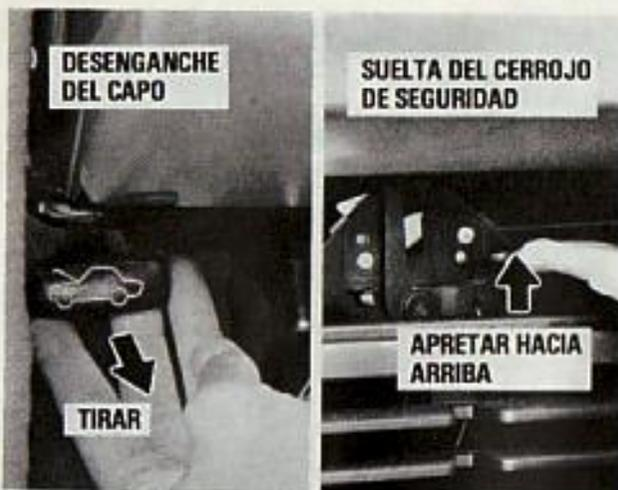
(1) Tire de la palanca de desenganche del cierre del capó que hay bajo el tablero y el capó se abrirá mediante su resorte un poco.
