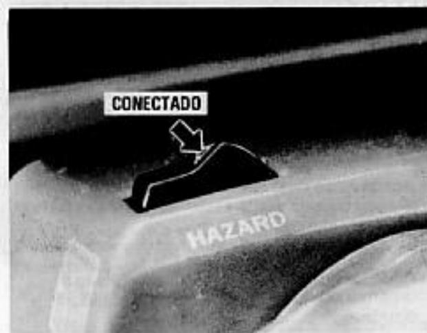
Para conectar las luces del intermitente de emergencia, tire del botón hacia afuera.
