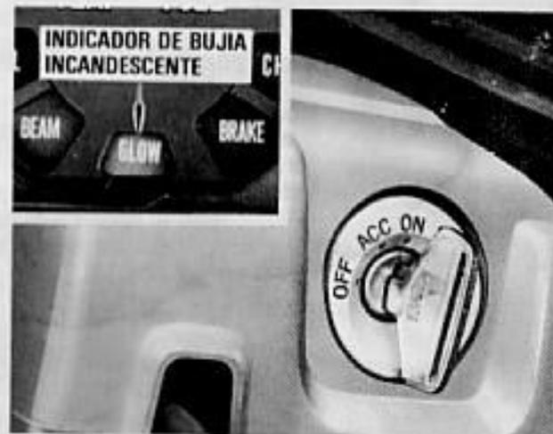
**"ON" (conexión) — Para conectar las bujías incandescentes y precalentar el motor antes de ponerlo en marcha. Después de arrancar el motor, la llave volverá a esta posición y se podrán accionar todos los accesorios.**
