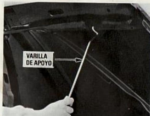
(3) Después de levantar el capó, manténgalo abierto levantando la varilla de apoyo hasta su lugar.
