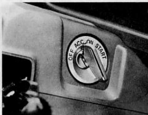
**"ACC" (accesorios) – El motor está desconectado, pero los accesorios tales como la radio pueden funcionar.**
