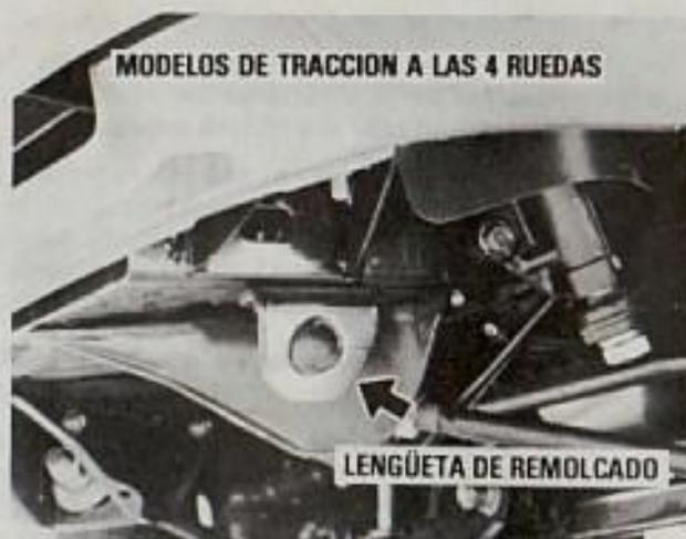
Para un remolcado de emergencia, asegure un cable o una cadena a la lengüeta de remolcado (modelos de tracción a las dos ruedas) o al gancho de remolcado (modelos de tracción a las cuatro ruedas) que hay en la parte inferior delantera de su vehículo.
