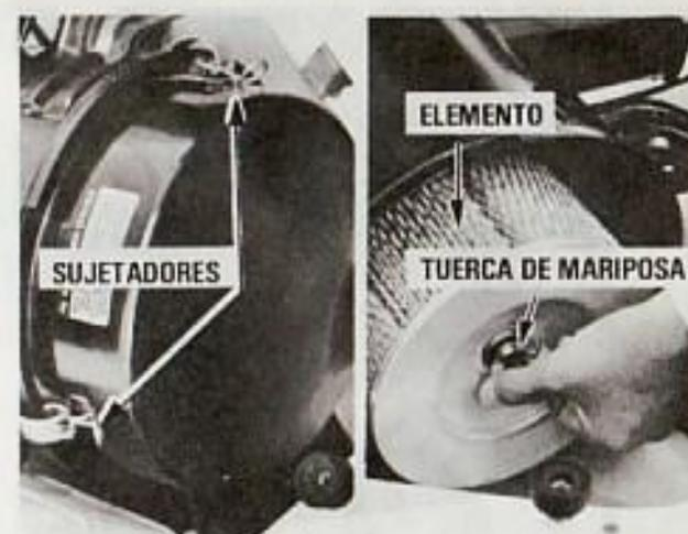
1. Para inspeccionar el elemento, suelte los sujetadores y saque la cubierta de polvo. Luego desenrosque la tuerca de mariposa y saque el elemento.
