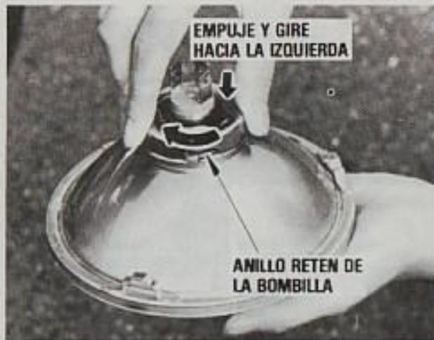
**1. Desconecte el conector de los cables, saque la cubierta de caucho tirando hacia afuera, saque el aro de retén de la bombilla y saque las bombillas.**
