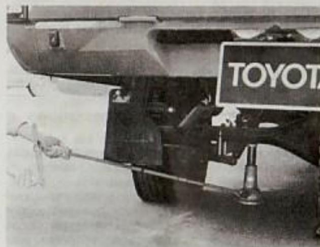
7. Levante el vehículo lo suficiente para poder instalar el neumático de repuesto.
