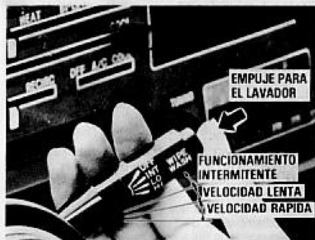
Para conectar los limpiadores, tire del interruptor hacia abajo. Para rociar con los lavadores, empuje el botón del extremo del interruptor.
