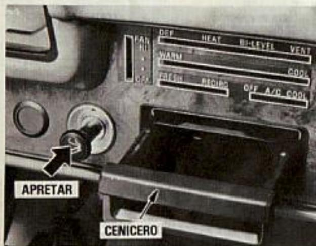
Empuje el encendedor hacia adentro, presionando, y automáticamente saldrá cuando esté preparado para usarlo.
