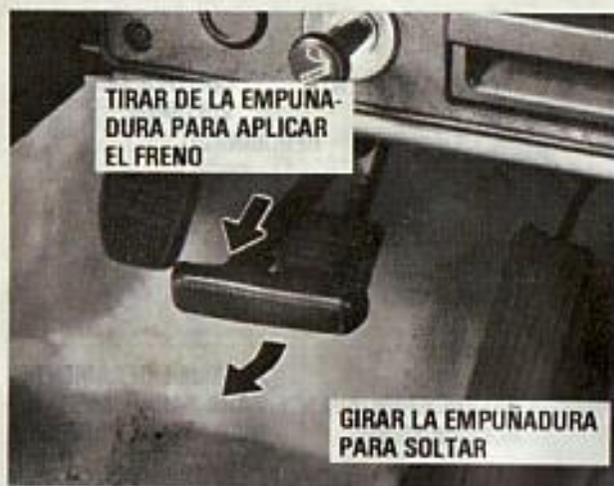
Para aplicarlo: Tire de la palanca hacia afuera. Para soltarlo: Tire hacia afuera ligeramente, gire el mango de la palanca y empuje.
