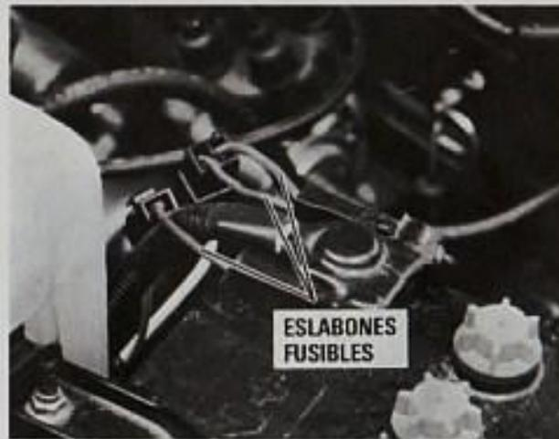
Para los carros vendidos en Alemania Occidental, los circuitos de la luz de parada, cola y estacionamiento van protegidos por un fusible en línea. Los fusibles están ubicados cerca del bloque de fusibles.
