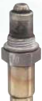
Tubo protector muy oxidado
