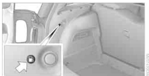
Tirar del botón verde con el símbolo del surtidor de combustible y se abre la tapa del depósito de combustible.
