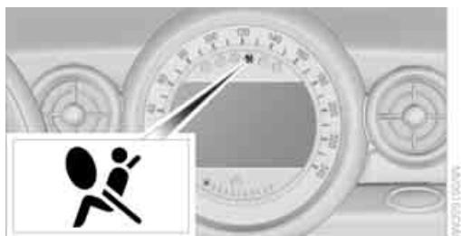
A partir de la disposición para el uso de la radio, página 47, se enciende brevemente el aviso luminoso e indica así la disposición para el funcionamiento del sistema airbag completo y del pretensor de cinturón.
