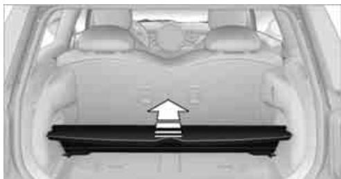
Levantar el piso de carga plano y plegarlo hacia delante, flecha.
