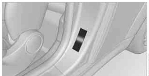
Encontrará las indicaciones de presión de inflado para las medidas de neumáticos autorizados en el montante de la puerta con la puerta del conductor abierta.
