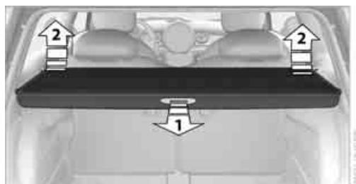
2. Sacar la cubierta del maletero hacia arriba fuera de sus sujeciones, flechas 2.
