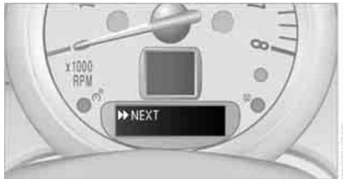
1. Dentro de un ajuste o de una información pulsar brevemente la tecla en el mando de los intermitentes hasta que se visualice «NEXT».
