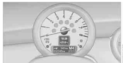
Evitar sin falta los regímenes de motor en el campo de advertencia rojo. Para proteger el motor se interrumpe en ese segmento la alimentación de combustible.
