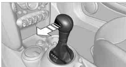
Desplazar al carril de comutación M/S la palanca selectora automático desde la posición D hacia la izquierda:
