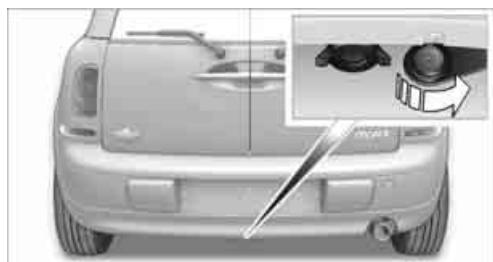
Se encuentran en los bajos del vehículo. Antes del montaje del enganche para remolque: Extraer hacia abajo la caperuza cobertera y girar hacia abajo la caja de enchufe para remolque, flecha.
