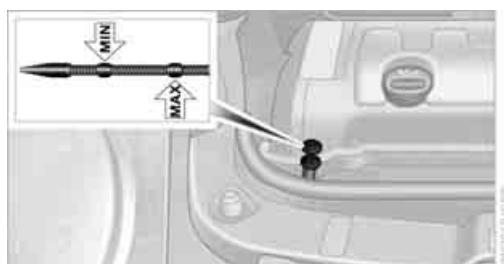
La cantidad de aceite entre las dos muescas de la varilla de nivel es de aprox. 1 litro, en el motor de gasolina y de aprox. 1,5 litros en el motor Diesel.
