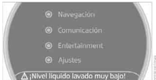
Los mensajes de texto de la parte inferior del display de control explican el significado de los testigos y avisos luminosos iluminados.
