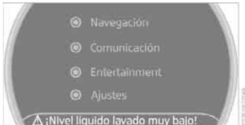
Los mensajes de texto de la parte inferior del display de control explican el significado de los testigos y avisos luminosos visualizados.
