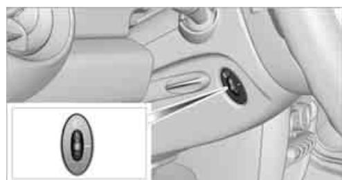
El alcance luminoso de la luz de cruce se ha de adaptar manualmente a la carga del vehículo, de lo contrario se deslumbra al tráfico que viene en sentido contrario.
