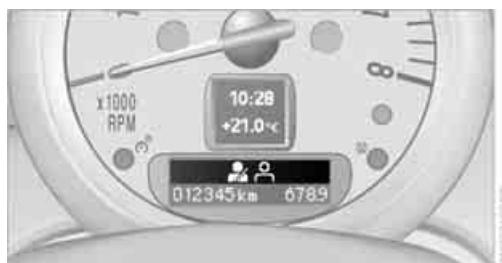
En la indicación se indica el cinturón que está abrochado en la parte trasera y cuál no.
