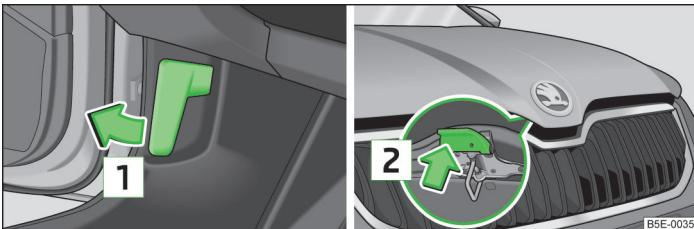
Fig. 180 Palanca de desbloqueo del capó / palanca de desbloqueo
