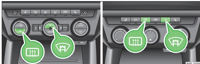
Fig. 39 Teclas para la calefacción del parabrisas y la luneta trasera Climatronic/aire acondicionado manual, calefacción
