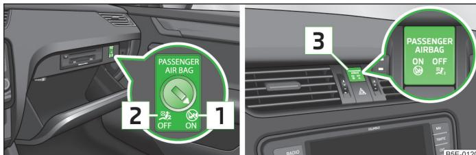
Fig. 170 Comutador de llave para el airbag frontal del acompañante / testigo de control para la conexión/desconexión del airbag frontal del acompañante
