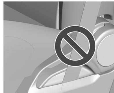
Posición incorrecta del cinturón de seguridad.
