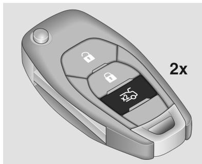
Para desbloquear la tapa del baúl, cuando el encendido está apagado, pulse el botón del control remoto de radio
