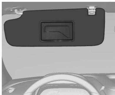
Los parasoles tienen espejos integrados se pueden abatir o bascular hacia un lado para evitar el encandilamiento.
