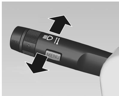
Para realizar un destello con los faros, tire de la palanca de las luces de giro.
