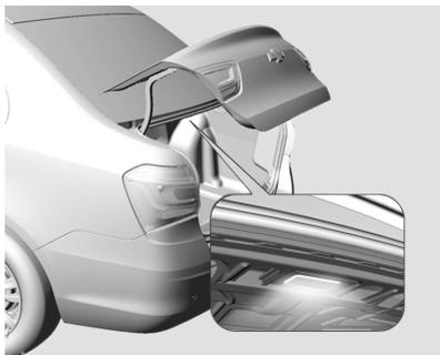
La iluminación se enciende al abrir la tapa del baúl y se apaga automáticamente cuando se cierra la tapa del baúl.
