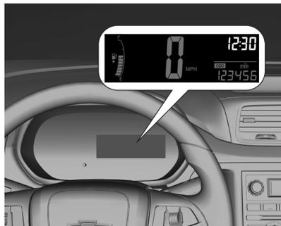
Para ajustar la hora en la pantalla modelo B, presione el botón del cuadro de instrumentos durante menos de 2 segundos como se muestra en la ilustración de abajo.
