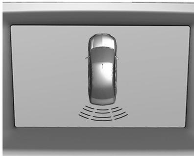
Se puede mostrar un triángulo de advertencia en la pantalla de la cámara de visión trasera (si está equipado), para proporcionar la distancia al objeto. Este triángulo cambia de ámbar a rojo y aumenta de tamaño cuanto más cerca está el objeto.
