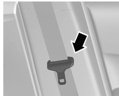
Cuando el cinturón de seguridad no esté en uso, coloque la lengüeta como se muestra en la figura para evitar ruidos causados por el contacto de la misma con el acabado de plástico de la columna.
