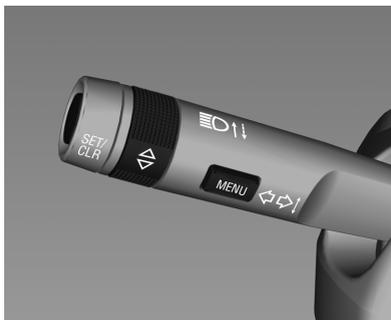
Se puede seleccionar el menú de configuración de unidades pulsando el botón de menú de la palanca de las luces de giro.
