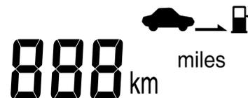
Este modo indica la distancia de conducción estimada para que se agote el combustible disponible actualmente en el depósito de combustible.
