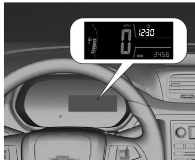
Para ajustar la hora en la pantalla modelo A, gire la perilla hacia arriba o abajo hasta que aparezca.
