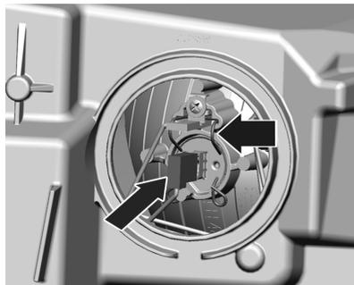
2. Desenchufe el conector de la lámpara.
