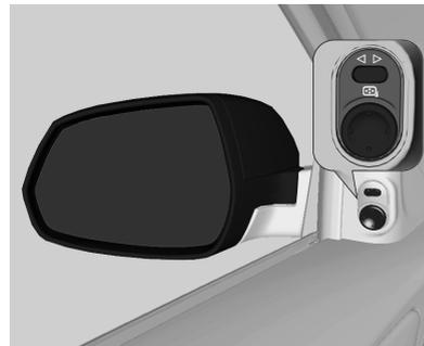
Seleccione el retrovisor izquierdo o derecho con el selector y ajústelo con la llave de cuatro posiciones.
