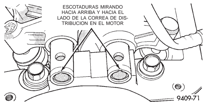
Fig. 25 Escotaduras del eje de balancín
