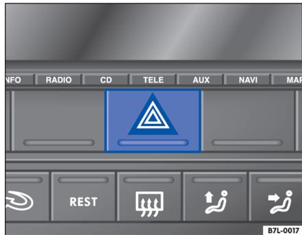
**Fig. 37** Tablero de instrumentos: conmutador de los intermitentes de emergencia
