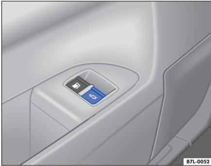
Fig. 31 Detalle de la puerta del conductor: tecla de apertura del portón trasero
