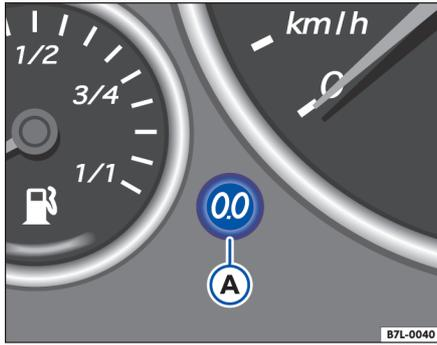
**Fig. 14** Detalle del tablero de instrumentos: tecla A para la puesta a cero del cuentakilómetros parcial
