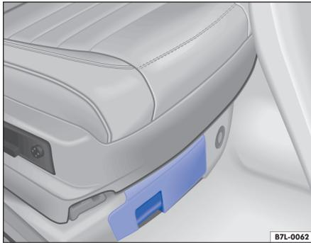
Fig. 70 Cajón debajo del asiento delantero derecho
