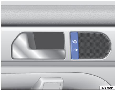
Fig. 20 Detalle de la puerta trasera izquierda: pulsador del cierre centralizado
