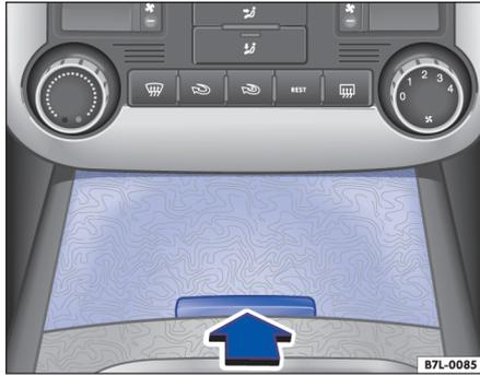
Fig. 62 Detalle de la consola central: portaobjetos
