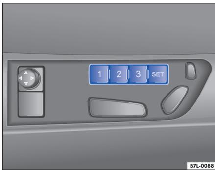
**Fig. 48** Teclas de memoria en el asiento delantero: para guardar pulsar primero la tecla SET y después una de las teclas de memoria 1, 2 ó 3.
