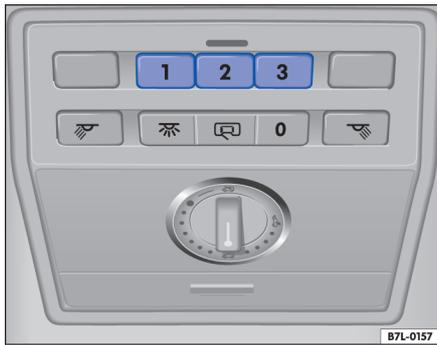
**Fig. 35** Detalle del guarnecido del techo: teclas de memoria para los mandos a distancia
