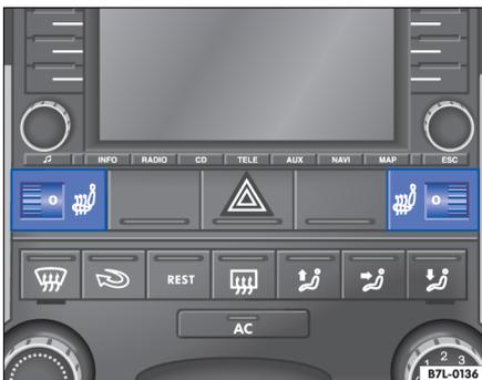
**Fig. 54** Tablero de instrumentos: ruedecillas moleteadas de la calefacción de los asientos delanteros
