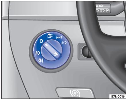
**Fig. 36** Tablero de instrumentos: mando de las luces, faros antiniebla y luz trasera antiniebla
