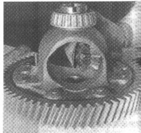
Montaje de los satélites y sus arandelas de fricción.
