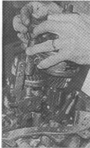
Desmontaje del conjunto de eje y horquillas.
