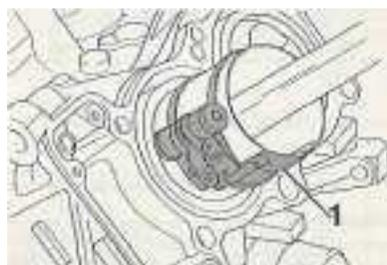
Mise en place des pistons dans leur cylindre à l'aide d'un compresseur de segment (1).
