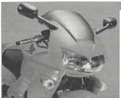
Les techniques nouvelles permettent d'obtenir des phares aux formes de plus en plus compliquées. Ici le double optique dit " en forme d'oeil de chat " est équipé de réflecteurs à surface complexe
