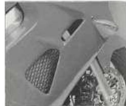
Afin d'accroître l'effet venturi pour permettre une meilleure évacuation de l'air chaud circulant au travers des deux radiateurs latéraux, le carénage de la VFR 800 FI reçoit de larges ouïes d'aération.
