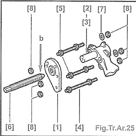
Nota : la position du plateau [1] est fonction du montage des vis [4] sur le bras; il faut le retourner suivant le côté de l'intervention.
