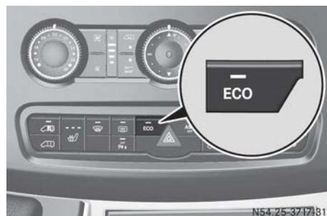
► Pulse la tecla **ECO** con el motor encendido. Si el testigo de control integrado en la tecla **ECO** está apagado, la función de parada y arranque ECO está desconectada. El motor ya no se para automáticamente al detener el vehículo.
