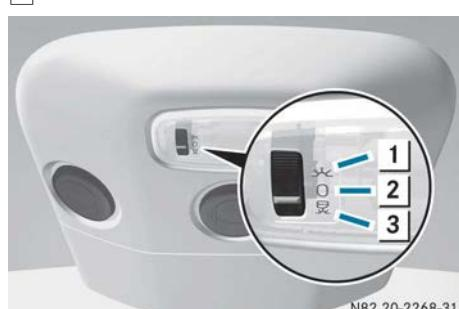
Luz interior con interruptor (ejemplo de un vehículo familiar con acondicionador de aire del espacio posterior)
