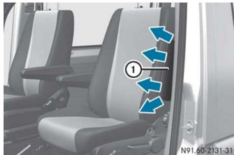
Los airbags laterales ① se despliegan junto a los refuerzos laterales exteriores del respaldo del asiento.
