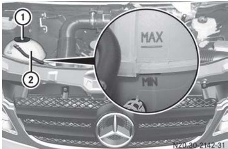
Tapón y depósito de expansión del líquido refrigerante (ejemplo)
