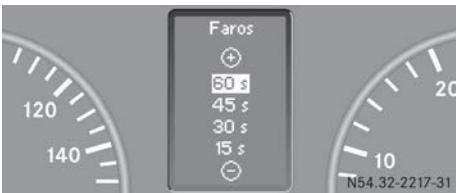
En el submenú **Faros** puede ajustar si deben permanecer o no encendidas las luces exteriores al cerrar las puertas y durante cuánto tiempo.
