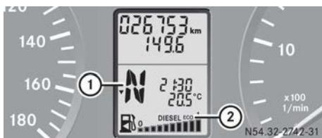
Indicaciones en el visualizador (ejemplo de un vehículo sin teclas en el volante de la dirección)
