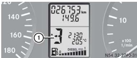
Recomendación de cambio de marcha (ejemplo de un vehículo sin teclas en el volante de la dirección)
