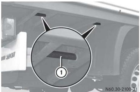
Puntos de amarre (ejemplo en camión con caja de carga)
