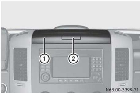
Compartimento portaobjetos situado en el puesto de conducción sobre la consola central (ejemplo con tapa)
