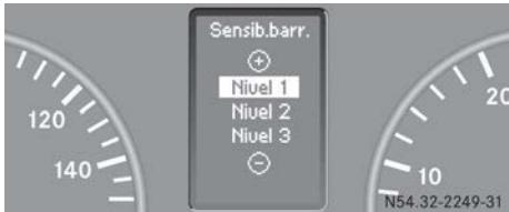
Con la función **Sensib.barr.** puede ajustar la sensibilidad del sensor de lluvia y luz.
