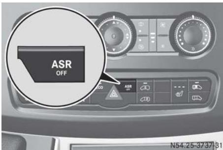
No desconecte el sistema ASR si se activa el sistema ESP® y parpadea el testigo de advertencia del cuadro de instrumentos. En este caso, pise el pedal acelerador solo lo necesario al iniciar la marcha.
