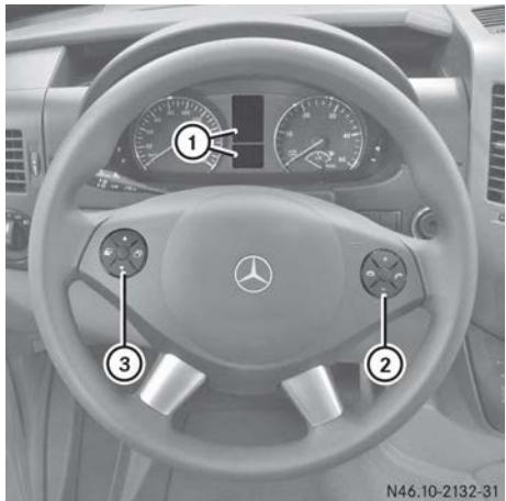
► **Activación del ordenador de a bordo:** gire la llave a la posición 1 de la cerradura de encendido.
