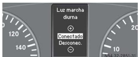
Si ajusta la luz de marcha diurna en la posición **Conectado**, cuando el motor esté en marcha se encenderá la luz de marcha diurna.
