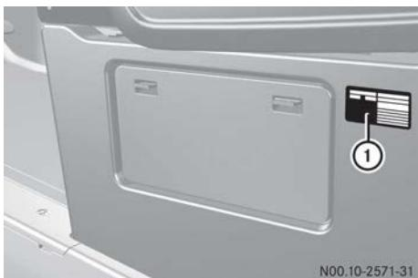
Placa de características del vehículo en la caja del asiento del conductor (ejemplo)
