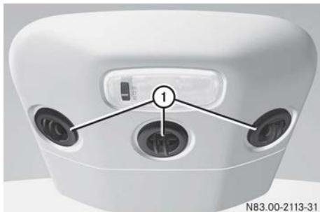
En los vehículos con acondicionador de aire del espacio posterior, hay integrados difusores de ventilación ajustables en el conducto de aire del techo.
