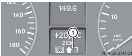
Recomendación de cambio de marcha (ejemplo de un vehículo con teclas en el volante de la dirección)
