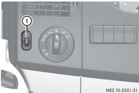
Con el regulador del alcance de las luces puede adaptar el cono luminoso de los faros al estado de carga del vehículo. El cono luminoso se modifica al ocupar los asientos o al cargar y descargar el compartimento de carga. En dicho caso, empeoraría la visibilidad y podría deslumbrar a los vehículos que circulan en sentido contrario.
