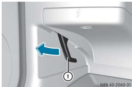
Palanca de desenclavamiento del capó del motor
