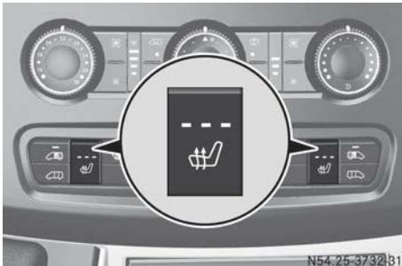
Los tres testigos de control rojos de la tecla muestran el nivel de calefacción **1 a 3** conectado.
