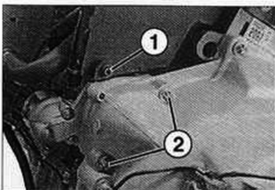
Desmontaje del motor de arranque. 1. Tornillo del aislamiento fónico - 2. Tornillo de fijación.
