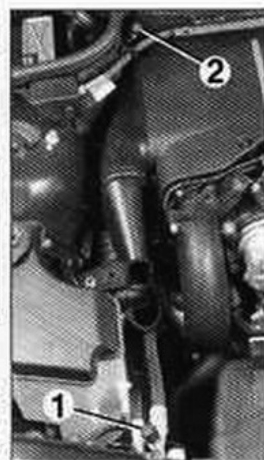
Situación de los racores de llenado del circuito de climatización. 1. Racor baja presión - 2. Racor alta presión.
