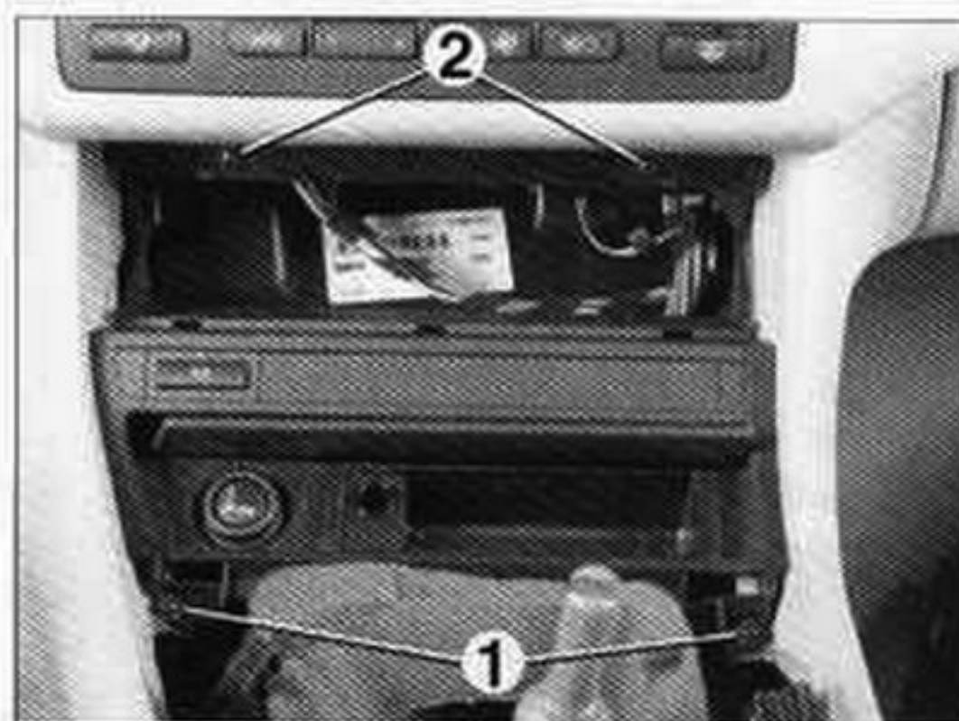
Desmontaje del conjunto cenicero-bandeja. 1. Tornillo de cenicero-bandeja. 2. Tornillo de bandeja.
