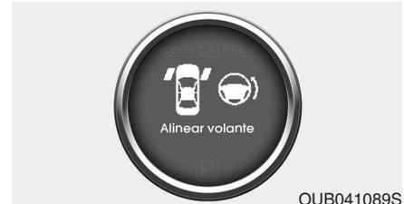
Si arranca el motor cuando el volante está girado 90° hacia la derecha tras unos segundos, el mensaje "Align steering wheel" (Alineación del volante) se ilumina en la pantalla LCD durante 5 segundos.
