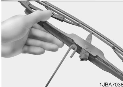
2. Presione el clip y deslice hacia abajo el conjunto de la escobilla.
