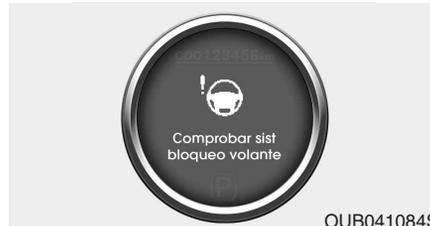
Si el volante no se bloquea como normalmente al colocar el botón de inicio/parada del motor en la posición OFF, la advertencia se ilumina durante 10 segundos en la pantalla LCD. La señal acústica de advertencia sonará durante 3 segundos y la luz del botón de inicio/parada del motor parpadeará durante 10 segundos.
