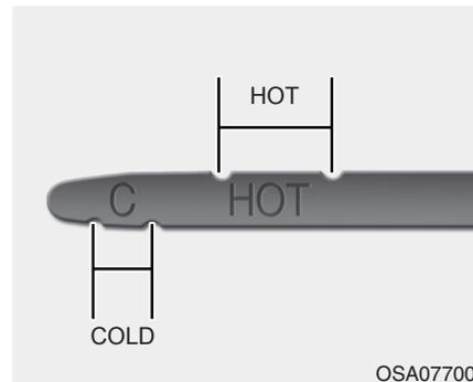
3. Compruebe que el nivel de líquido está en el margen "HOT" en el indicador de nivel. Si el líquido es inferior, añada el líquido específico por el orificio del llenado. Si el líquido es superior, drene el líquido específico por el orificio del drenaje.
