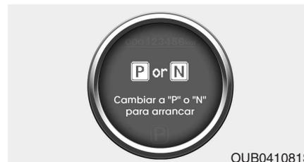
Si intenta arrancar el motor sin la transmisión en la posición P (estacionamiento) o N (punto muerto), la advertencia se ilumina durante 10 segundos en la pantalla LCD.
