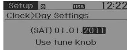
\* Ajuste el número marcado para fijar los ajustes y pulse el mando TUNE para pasar al ajuste siguiente. (Ajustar por el orden de día/mes/año.)
