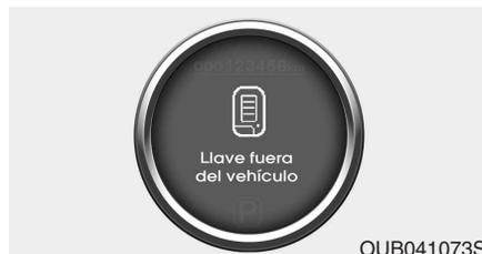
Si la llave smart no está en el vehículo y si se abre o se cierra alguna puerta con el botón de inicio/parada del motor en posición ACC, ON o START, la advertencia ilumina la pantalla LCD. La señal acústica sonará durante 5 segundos cuando la llave smart no esté dentro del vehículo y la puerta esté cerrada.
