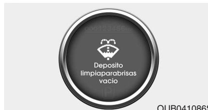
Este testigo de advertencia se ilumina durante 10 segundos cuando la reserva del líquido del lavaparabrisas está casi vacía. Para apagar inmediatamente el testigo de advertencia, pulse el botón TRIP durante más de 4 segundos. Rellene el depósito tan pronto como sea posible.
