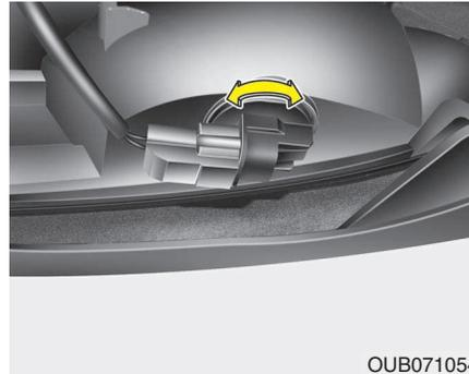
5. Monte de nuevo el portalámparas en la carcasa alineando las lengüetas del portalámparas con las ranuras de la carcasa. Inserte el portalámparas en la carcasa y gire el casquillo en sentido horario.
