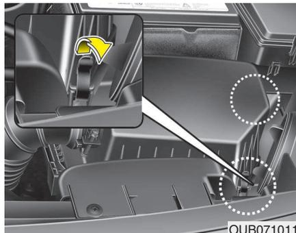
1. Suelte los clips que sujetan la tapa del filtro de aire y levante la tapa.
