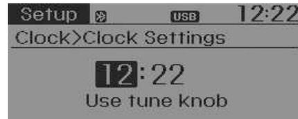
\* Ajuste el número marcado para fijar la [hora] y pulse el mando TUNE para fijar los [minutos].
