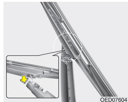
2. Monte un nuevo conjunto de la escobilla colocando la parte central en la ranura del brazo del limpiaparabrisas hasta que encaje en sus sitio.
