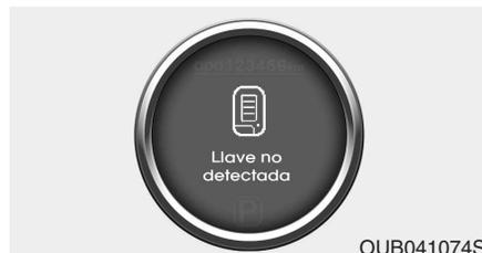
Si la llave smart no está en el vehículo o no se detecta y usted pulsa el botón de inicio/parada del motor, las luces de advertencia de la pantalla LCD se iluminarán durante 10 segundos. El indicador del inmovilizador parpadearán durante 10 segundos.
