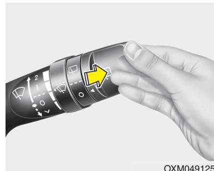
Empuje la palanca alejándola de usted para pulverizar líquido limpiacristales en la luna trasera y para activar el limpiaparabrisas trasero 1~3 ciclos. El rociado y el funcionamiento del limpiaparabrisas continuarán hasta que suelte la palanca.
