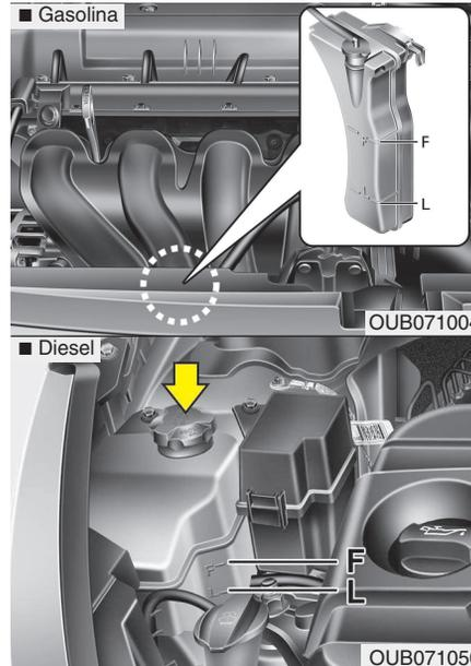
Si el nivel de refrigerante es bajo, añada suficiente agua destilada (desionizada) o blanda para una protección contra la corrosión y el congelamiento. Haga que el nivel llegue a la F, pero no llene con exceso. Si se necesita añadir frecuentemente, haga que un concesionario autorizado de KIA revise el sistema de refrigeración.
