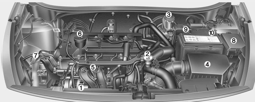
1. Depósito de refrigerante del motor....7-38
