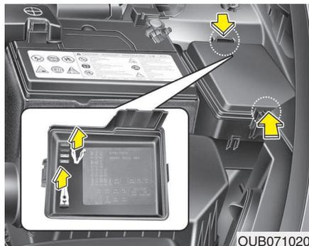
3. Tire del fusible averiado. Utilice la herramienta de desmontaje que está en el panel de fusibles del compartimento del motor.
