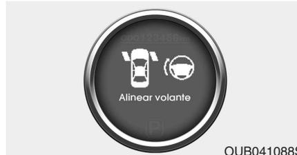
Si arranca el motor cuando el volante está girado 90° hacia la izquierda tras unos segundos, el mensaje "Align steering wheel" (Alineación del volante) se ilumina en la pantalla LCD durante 5 segundos.
