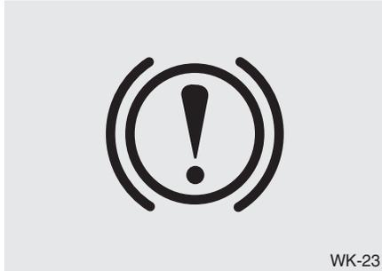
Compruebe el piloto de aviso de freno girando la llave de contacto a la posición ON (sin arrancar el motor). Este piloto se iluminará siempre que se aplique el freno de estacionamiento mientras el contacto está en las posiciones START u ON.
