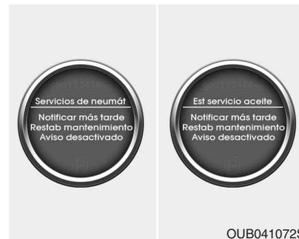
2. Si desea reajustar o desactivar el sistema de mantenimiento, pulse el botón RESET durante más de 1 segundo. La pantalla conmutará al modo "Mensaje de servicio del aceite del motor".
