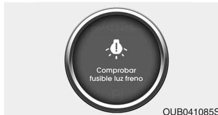
Cuando el fusible de la luz de freno está desconectado, la luz de advertencia se ilumina durante 10 segundos en la pantalla LCD.
