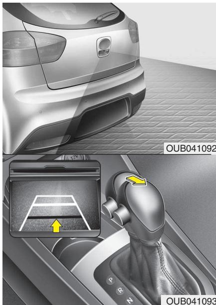
La cámara de visión trasera se activará cuando se encienda la luz de marcha atrás con el interruptor de encendido en ON y la palanca de cambios en la posición R (marcha atrás).
