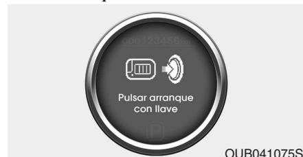
Si pulsa el botón de inicio/parada del motor durante el estado de "Llave no detectada", se ilumina la advertencia "Pulse de inicio con la llave smart" durante 10 segundos en la pantalla LCD. El indicador del inmovilizador parpadea durante 10 segundos.
