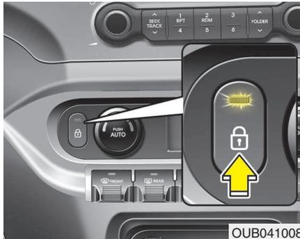
**Con el interruptor de desbloqueo/ bloqueo centralizado de puertas**
