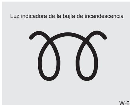
3. Gire la llave de contacto a la posición ON para precalentar el motor. La luz indicadora de la bujía de incandescencia se iluminará.
