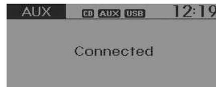
\* El modo AUX no puede ponerse en marcha a menos que se haya conectado un dispositivo externo en el terminal AUX.
