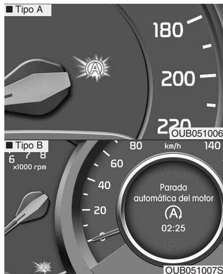
El motor se parará y el indicador verde de PARADA AUTOMÁTICA (A) se encenderá en el tablero de instrumentos. Si su vehículo está equipado con un tablero de instrumentos de supervisión, el aviso se iluminará en la pantalla LCD.
