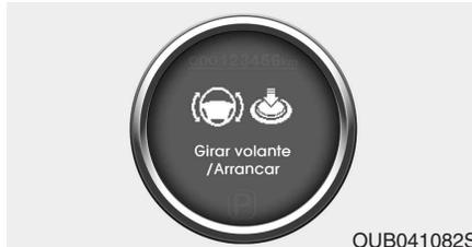
Si el volante no se desbloquea como normalmente cuando se pulsa el botón de inicio/parada del motor, la advertencia se ilumina durante 10 segundos en la pantalla LCD. La señal acústica de advertencia sonará una vez y la luz del botón de inicio/parada del motor parpadeará durante 10 segundos.
