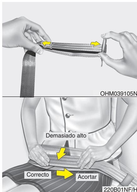
Con los cinturones estáticos de 2 puntos de anclaje hay que ajustar la longitud manualmente para que se ciña al cuerpo. Enganche el cinturón y tire del extremo libre para apretarlo. Coloque el cinturón tan bajo sobre las caderas como pueda, no en la cintura. Si el cinturón está demasiado alto, aumenta la probabilidad de sufrir lesiones en caso de accidente.
