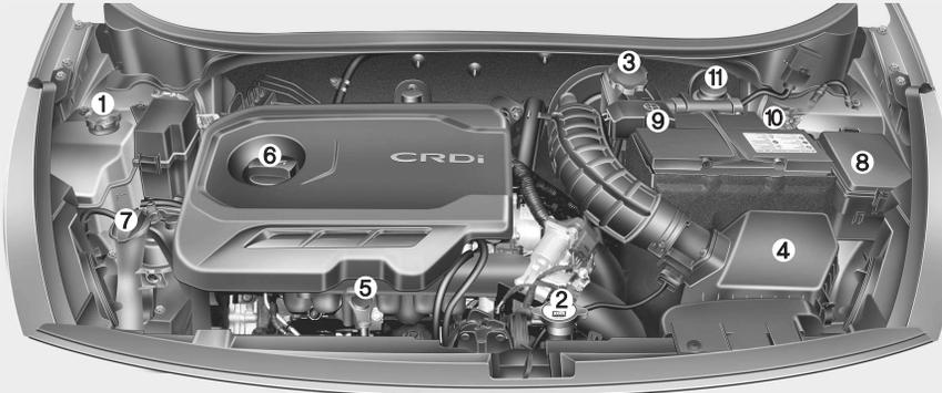
1. Depósito de refrigerante del motor
