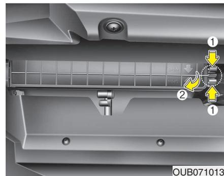
2. Extraiga la cubierta del filtro de aire del control del climatizador pulsando el bloqueo a la derecha de la cubierta.
