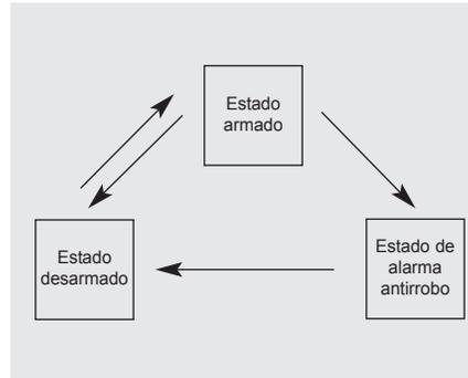
Este sistema está diseñado para proteger frente a la entrada no autorizada al vehículo. Funciona en tres etapas: la primera es “Armado”, la segunda “Alarma antirrobo” y la tercera “Desarmado”. Cuando se activa, el sistema proporciona una alarma acústica y enciende los intermitentes de emergencia.
