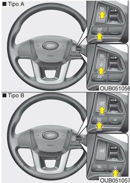
Su pulsa el interruptor CANCEL una vez, el límite de velocidad ajustada se cancelará, pero el sistema no se apagará. Si desea reajustar el límite de velocidad, suba la palanca (a RES+) o bájela (a SET-) hasta alcanzar la velocidad deseada.
