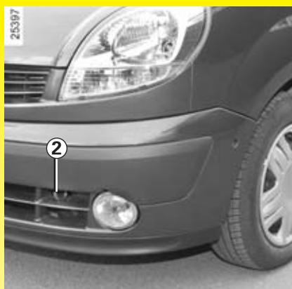
Según el vehículo, utilice exclusivamente los puntos de remolcado delantero 1, 2, o 3 o trasero 4 o 5 (nunca los tubos de transmisión). Estos puntos de remolcado solamente pueden ser utilizados para tirar “linealmente”; en ningún caso deben servir para levantar directa o indirectamente el vehículo.
