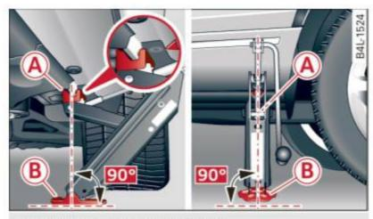
Fig. 253 Sill: positioning the jack
