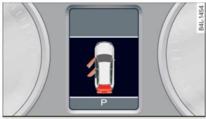
Fig. 13 Display: open door or rear lid warning
