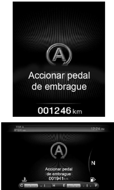
Si no se pressiona el pedal de embrague en aproximadamente 3 minutos, un mensaje será exhibido en la pantalla (Off o Start&Stop no disponible); en ese caso el rearranque automático estará deshabilitado, siendo necesario efectuar el nuevo arranque del vehículo a través de la llave de arranque.
