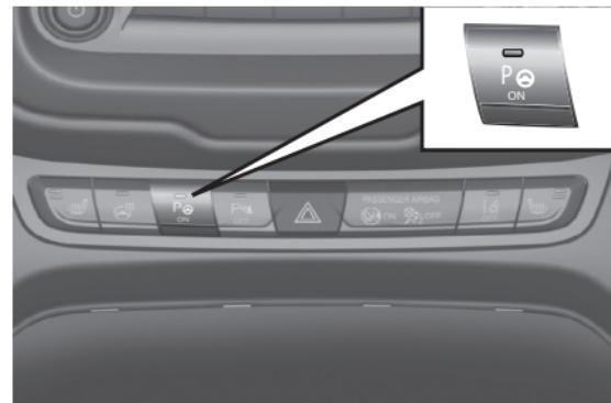
Las luces de LED también se encienden en caso de avería en el sistema Active ParkSense®. Pulsando el botón con el sistema averiado, el LED parpadea unos 5 segundos y luego permanece apagado.
