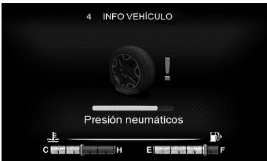
El sistema iTPMS avisa al conductor sobre la eventual presencia de una condición de presión de llenado diferente de la condición en el momento de la puesta a cero, si esa presión baja a un valor inferior al límite de advertencia por cualquier motivo, incluyendo los efectos de la baja temperatura y la normal pérdida de presión del neumático.
