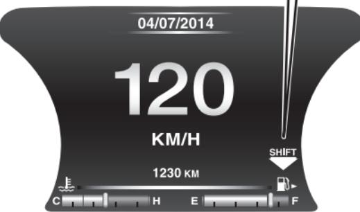
La indicación en la pantalla permanece encendida hasta que el conductor efectúa el cambio de marcha o mientras las condiciones de marcha sigan un perfil de viaje que requiera un cambio de marcha para reducir el consumo.
