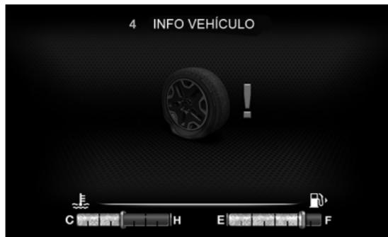
**IMPORTANTE:** el conductor no debe realizar la puesta a cero en el caso descrito anteriormente. En cuanto el sistema vuelve a recibir señales precisas de la condición de llenado de los neumáticos, el testigo se apagará y el sistema volverá a funcionar normalmente.
