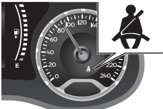
Con el vehículo parado, si el cinturón de seguridad del conductor o el cinturón de seguridad del lado pasajero está desabrochado (con pasajero sentado) el testigo permanece encendido con luz fija.
