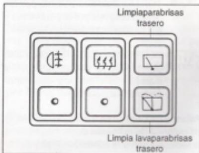
Al presionar el pulsador del limpiaparabrisas. Funciona la escobilla de la luneta trasera. Al presionar de nuevo sobre el pulsador, la escobilla retorna a la posición inicial y se para.
