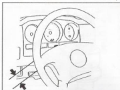
Revise el juego del volante de dirección girándolo suavemente en ambas direcciones. El juego del volante debe estar entre 10—30 mm. Compruebe que el volante de dirección gire ligera y suavemente hacia derecha e izquierda, mientras circula lentamente en lugares despejados. Si descubre alguna anomalía, consulte con su distribuidor SUZUKI.
