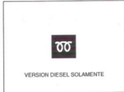
**Testigo de precalentamiento. (según versiones)**
