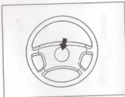
Presione el botón situado en el volante de dirección para hacer sonar la bocina. La bocina sonará independientemente de la posición del interruptor de encendido.
