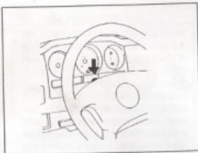
Para activar las luces de aviso de peligro, pulse el interruptor correspondiente. Las cuatro luces de señal de giro y los dos indicadores de señal de giro, lucirán simultáneamente.
