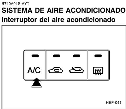
El aire acondicionado será conectado o desactivado mediante el pulsador de control.
