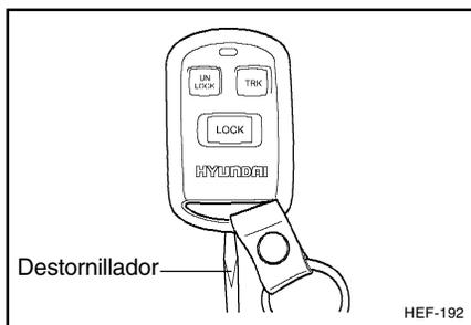
1. Abra la caja con un destornillador plano como se indica en la figura.
