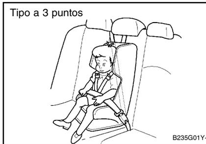
Utilizzare la cintura di sicurezza centrale del sedile posteriore per assicurare il sistema di trattenuta per bambini come illustrato. Una volta installato il sistema di trattenuta per bambini, fare oscillare il seggiolino avanti e indietro, e
