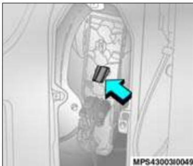
2. Pressione a lingüeta de retenção do suporte das lâmpadas e remova o conjunto, puxando-o para fora.
