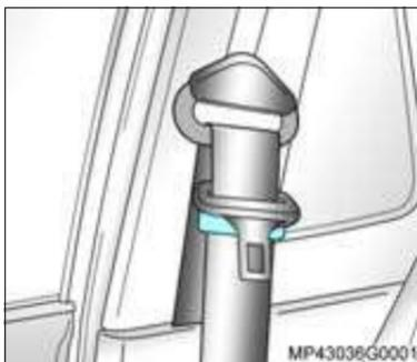
Quando o cinto de segurança do passageiro não estiver sendo utilizado, posicione o clipe manualmente, de modo que a fivela fique próxima da guia do cinto de segurança.
