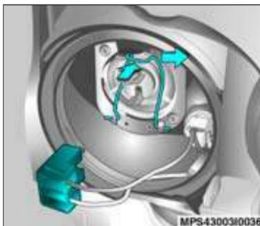
3. Solte a conexão da lâmpada.
