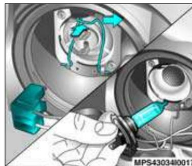
3. Solte a conexão da lâmpada.
