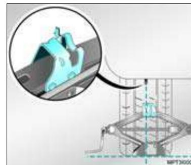
9. Posicione o braço do macaco no encaixe mais próximo da roda a ser substituída, de modo que a garra do macaco envolva a lâmina vertical e encaixe no rebaixo da lâmina.
