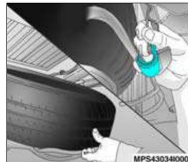
3. Solte o gancho de fixação do suporte, possibilitando a remoção da roda reserva, juntamente com a sua bandeja.
