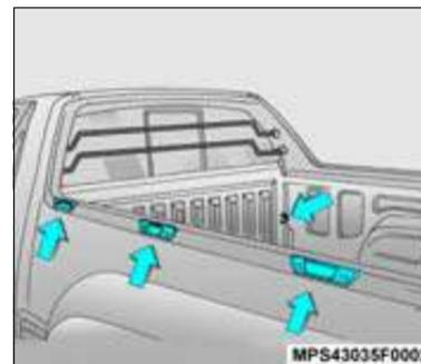
Na parte externa e interna do compartimento de carga existem ganchos destinados a passagem de cordas ou prendedores elásticos para a imobilização de carga.
