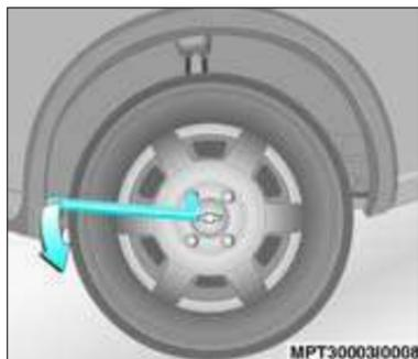
7. (Roda com calota integral e de alumínio) Com a chave de roda, afrouxe os parafusos 1/2 a 1 volta; não os remova.
