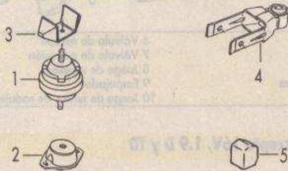
1 Soporte elástico dcho. 2 Soporte elástico izdo. 3 Tope elástico 4 Bieleta de soporte 5 Tope elástico 2.0i-16V
