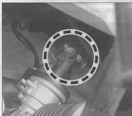
Implantation du boulon de fixation du cardan.
