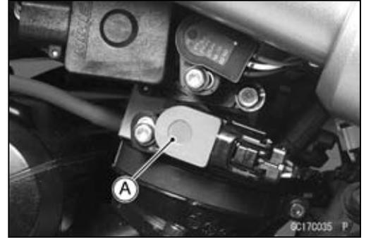
**Comprobación del voltaje de entrada del sensor del acelerador**
