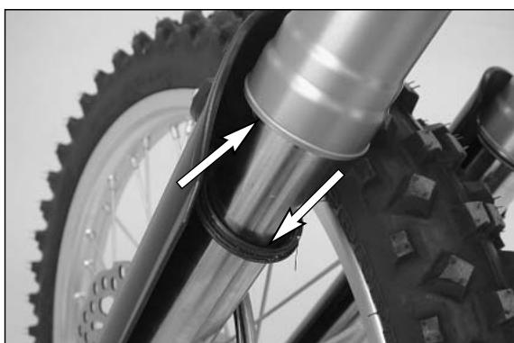
Limpiar cuidadosamente los fuelles, los tubos exteriores y las barras de la horquilla y lubrificarlos bien con un spray de silicona o con aceite para motor. Finalmente, apretar bien los fuelles antipolvo en los tubos exteriores con la mano.
