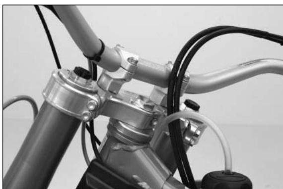
Montar la tija inferior, el cojinete de la pipa de dirección superior, el anillo de seguridad, el aro tórico, la tija superior y el tornillo de cierre. Apretar el tornillo collar de la tija inferior con 60 Nm. Montar las botellas de las horquillas y atornillar los tornillos de fijación de la tija inferior en 3 pasos con 10 Nm.
