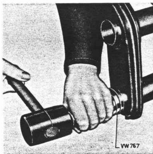
Fig. 15 Remove the torsion arm bearings. Fig. 15 Chasser les roulements des leviers de suspension. Fig. 15 Remover los rodamientos de los brazos de suspensión.
