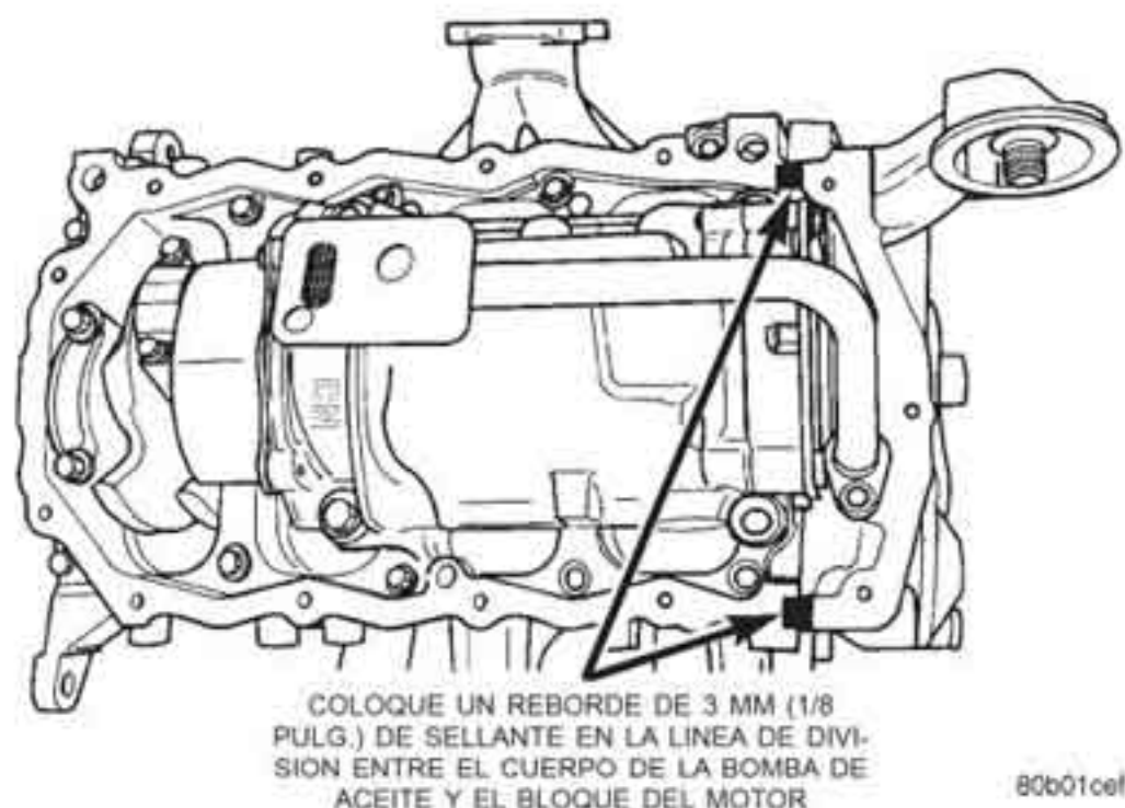
Fig. 67 Sellado del colector de aceite
