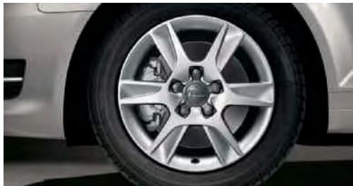
Llantas de invierno de aleación en diseño de 6 radios, tamaño 6,5 J x 16 con neumáticos 205/55 R 16, no aptas para cadenas, velocidad máxima tolerable 210 km/h.
