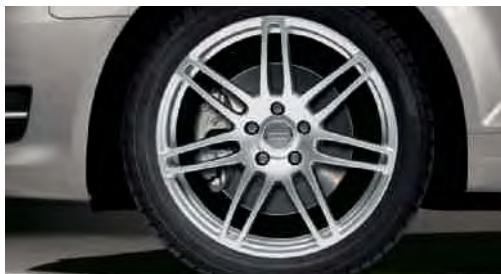
Llantas de aleación Audi exclusive en diseño de 7 radios dobles, tamaño 7,5 J x 18 con neumáticos 225/40 R 18. Oferta de quattro GmbH.
