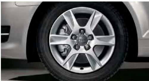
Llantas de aleación en diseño de 6 radios, tamaño 6,5 J x 16 con neumáticos 205/55 R 16.
