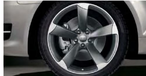
Llantas de aleación Audi exclusive en diseño de 5 brazos Rotor, en óptica de titanio, torneado brillante, tamaño 7,5 J x 18 con neumáticos 225/40 R 18. Oferta de quattro GmbH.
