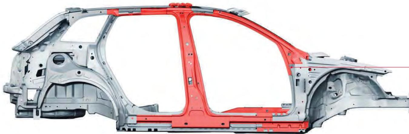
**Todos los vehículos están equipados con unas carrocerías especialmente estables dotadas de refuerzos en puntos concretos.** El alto porcentaje de aceros de alta y altísima resistencia configura unos modelos compactos, sin detrimento del placer de conducción. En la imagen, están marcados en rosa. Además, el Audi A3 Cabrio disfruta de los arcos antivuelco de la capota realizados en tubo de acero de alta resistencia que, además de seguridad, proporcionan al automóvil otro toque de dinamismo.
