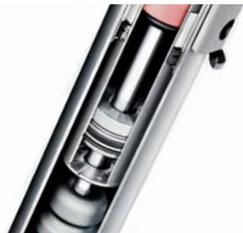
**El núcleo del amortiguador** es un pistón con una bobina inductora. A través de este pistón fluye el aceite de amortiguación, que está influido por un campo magnético variable. Si se aumenta la resistencia al flujo, aumentan también las fuerzas de amortiguación. Para ello, las partículas de hierro contenidas en el aceite se alinean a lo largo de las líneas del campo magnético.
