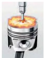
**La preinyección** comporta una combustión "blanda" y, en consecuencia, una excelente acústica de combustión y un agradable rodamiento del motor.
