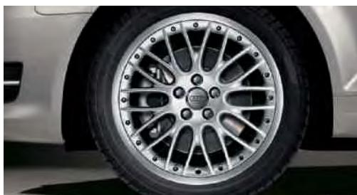
Llantas de aleación Audi exclusive en diseño de 20 radios, de dos piezas, tamaño 7,5 J x 18 con neumáticos 225/40 R 18. Oferta de quattro GmbH.
