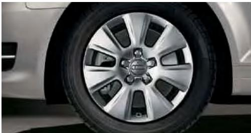
Llantas de aleación en diseño de 7 brazos "Parábola", tamaño 6 J x 15 con neumáticos que ahorran carburante 195/65 R 15 con resistencia al rodamiento mejorada.
