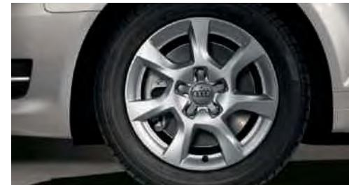
Llantas de invierno de aleación en diseño de 7 radios, tamaño 6,5 J x 16 con neumáticos 205/55 R 16, no aptas para cadenas, velocidad máxima tolerable 210 km/h.
