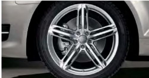
Llantas de aleación Audi exclusive en diseño de 5 radios segmentados, tamaño 7,5 J x 18 con neumáticos 225/40 R 18. Oferta de quattro GmbH.
