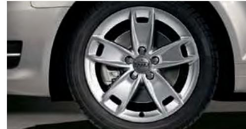
Llantas de invierno de aleación en diseño de 5 brazos, tamaño 6 J x 17 con neumáticos 205/50 R 17, aptas para cadenas, velocidad máxima tolerable 210 km/h. (Como opción con neumáticos con propiedades de rodadura de emergencia). (No disponibles en España).
