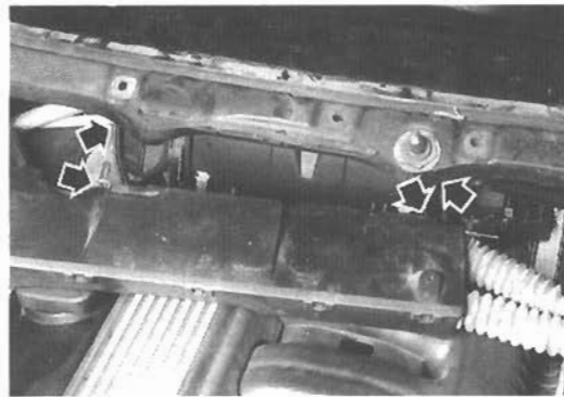
Tornillos de fijación del bloque de calefacción.
