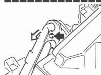
Tornillos de fijación de la brida al radiador y del radiador al bloque de calefacción.
