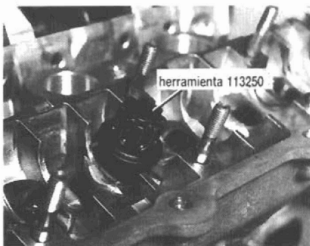
Colocación de las ventosas que evitan la caída de los empujadores.
