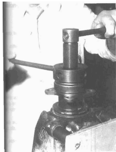
Colocación de la brida de arrastre con la herramienta BMW 231 300.
