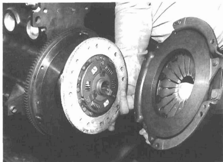
Sentido de montaje del disco de embrague.
