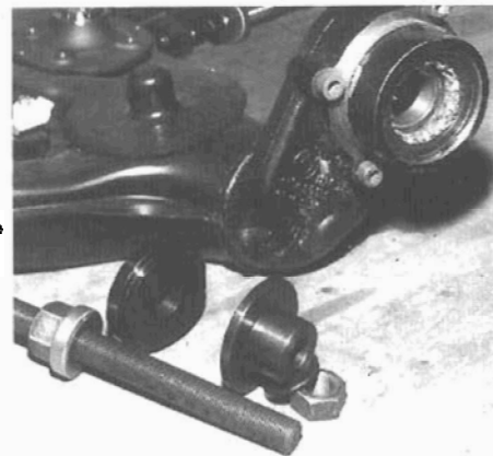
Colocación del rodamiento y vista del sistema de calado con tornillo.
