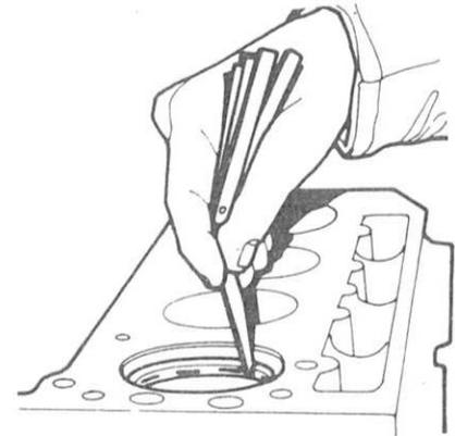
Una comprobación de la abertura entre puntas puede efectuarse introduciendo el segmento a comprobar en su cilindro y haciéndolo descender con un pistón; la abertura entre puntas medida con una galga debe ser:
