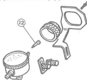
Montar en la bomba los útiles AAZ-AB-AC el comparador (F) en apoyo con el palpador (AD) para garantizar el contacto comparador/palpador, sustituir la punta de contacto por el prolongador 8.0703 J2 (cofre 8.0703).
