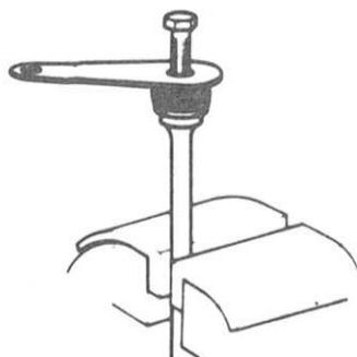
Untar la rosca y el extremo del tornillo 7.0908 R con un producto de deslizamiento y atornillarlo en la palanca izquierda hasta tomar apoyo sobre la barra.
