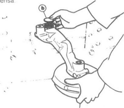
Meter la arandela separadora (b) (a realizar por el taller) en el mandrinado del brazo, asegurarse que está bien apoyada en la placa.
