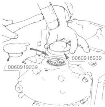
Introducir el retén de estanqueidad con la ayuda del útil y poner el capuchón protector y de mantenimiento Ref.: 0060919239. Regular la precarga de los rodamientos.
